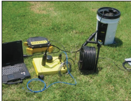
Strumento di misura DaqLinkIII
