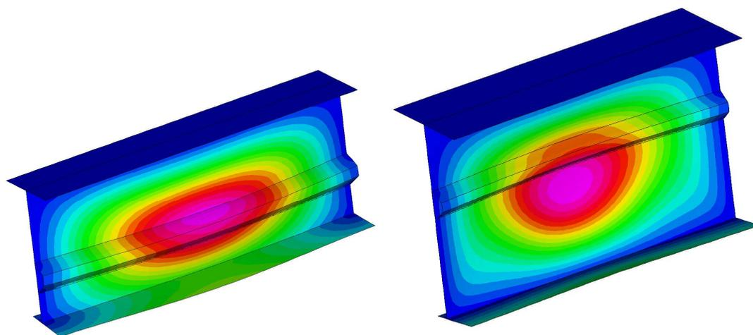
Figura 22: Deformata associata al primo modo di instabilità
