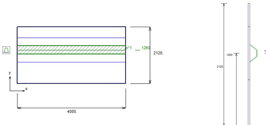
Figura 18: Geometria e posizione dell'irrigidente implementato nel modello
