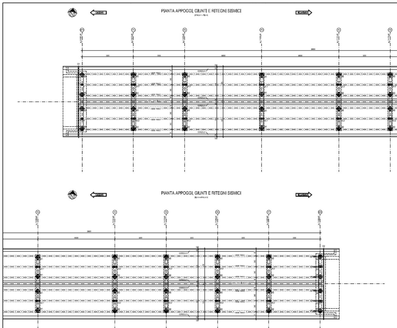
Figura 33 – Pianta appoggi e giunti.
