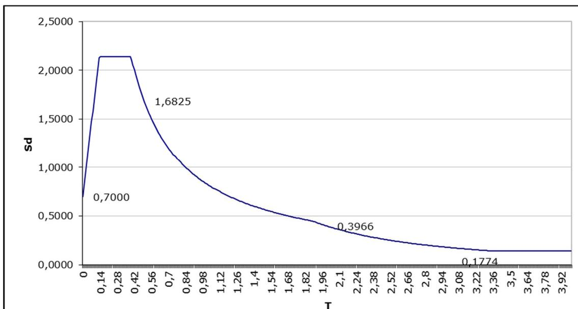
Figura 6 – Spettro di risposta allo SLV
