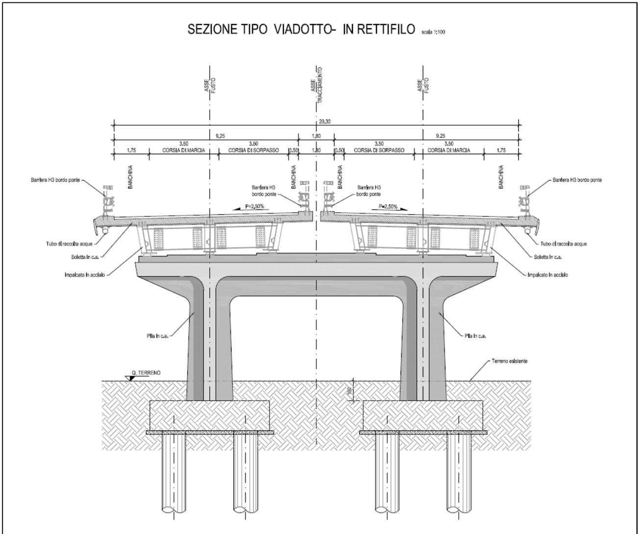
Figura 3 – Sezione dell'impalcato
