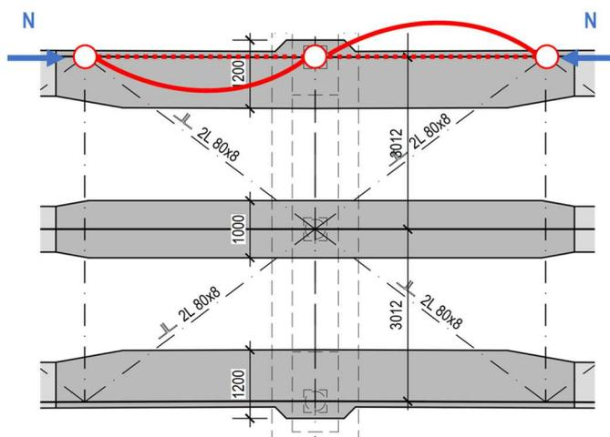
Figura 20: Schema di calcolo per la stabilità delle piattabande inferiori
