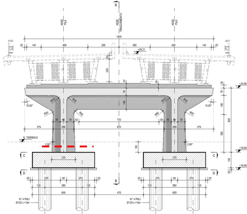
Figura 77 – Sezione di verifica del fusto della pila
