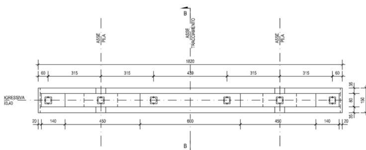
Figura 67 – Pila Tipo – Pianta pulvino e sezione fusto
