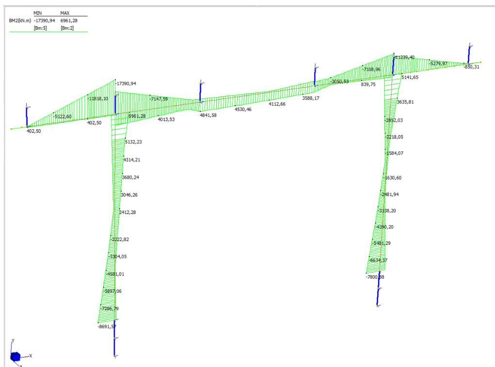
Figura 68 – Involuppo diagramma del momento flettente
