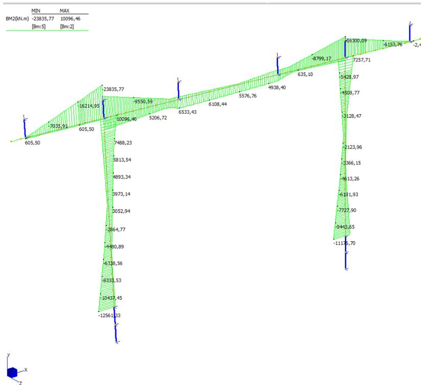
Figura 80 – Involuppo diagramma del momento flettente
