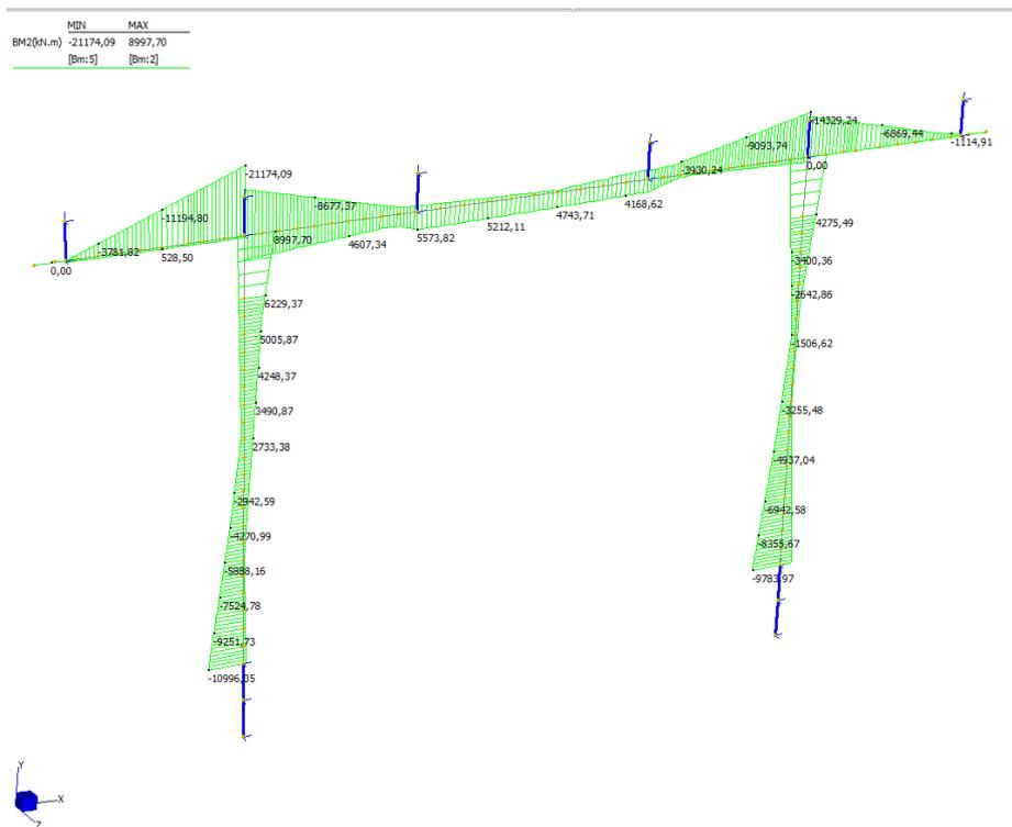
Figura 74 – Involuppo diagramma del momento flettente
