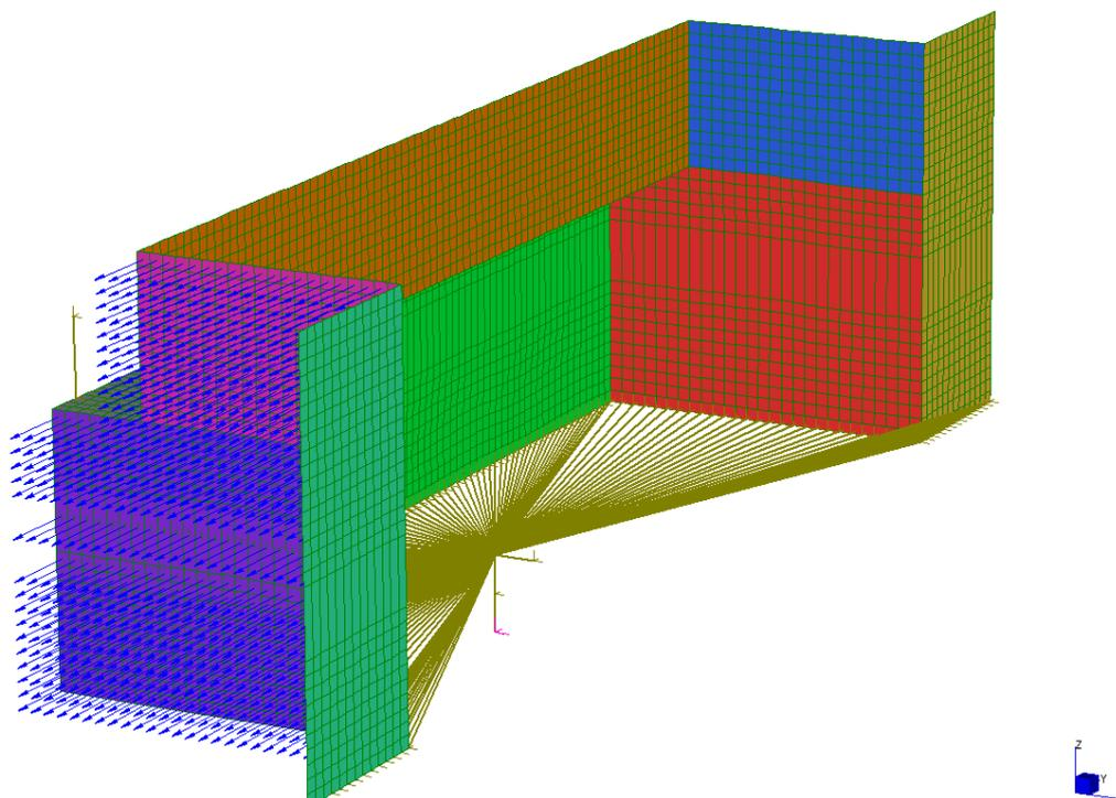
Figura 24: Sovrappinta sismica di Wood sui muri -Y
