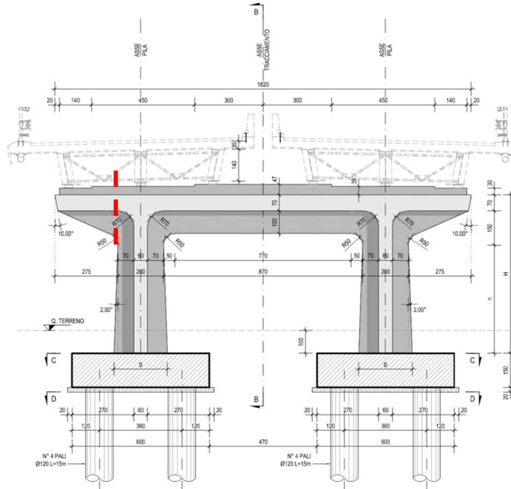
Figura 85 – Sezioni di verifica del trasverso della pila
