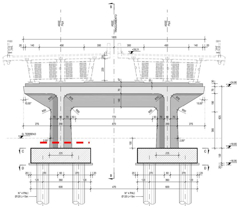
Figura 71 – Sezione di verifica del fusto della pila
