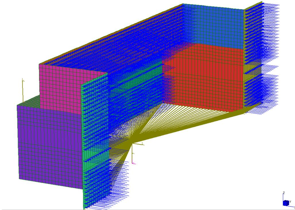
Figura 22: Sovrappinta sismica di Wood sul fusto
