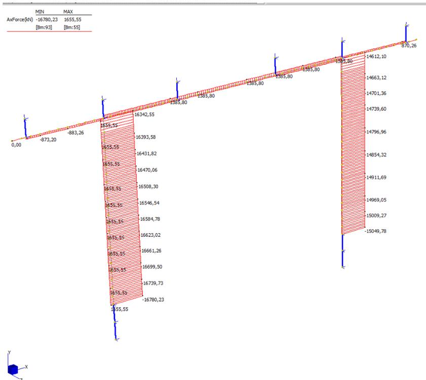
Figura 82 – Involuppo diagramma dell'azione assiale
