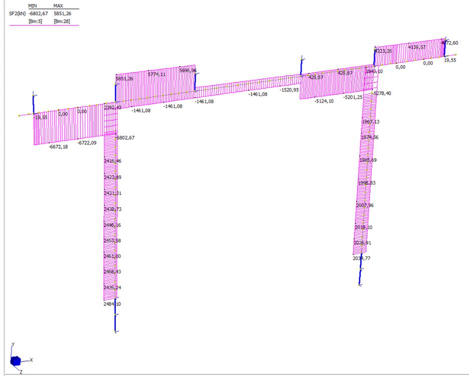
Figura 75 – Involuppo diagramma dell'azione tagliante
