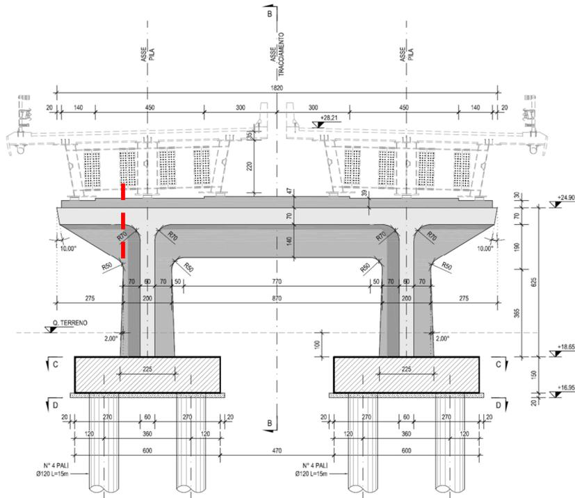
Figura 73 – Sezioni di verifica del trasverso della pila
