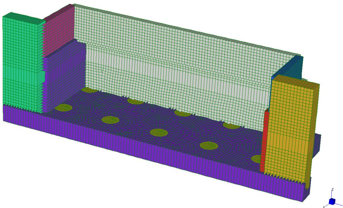
Figura 14: Modello con platea - Vista tridimensionale retro - Spalla 2
