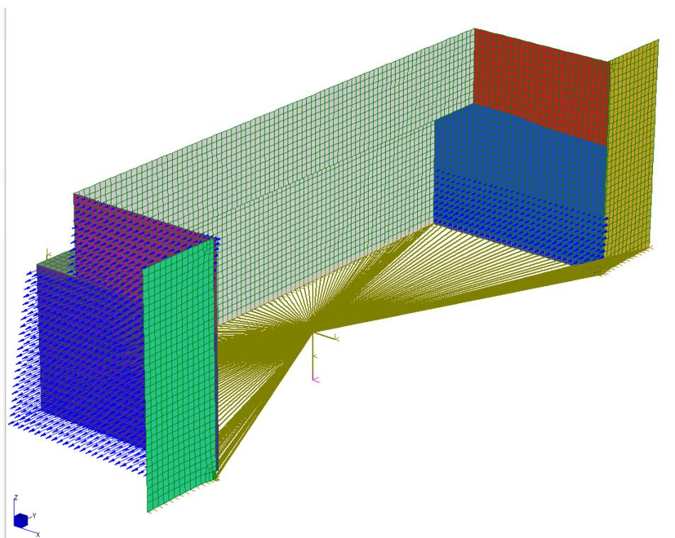
Figura 20: Spinta orizzontale del terreno direzione -Y
