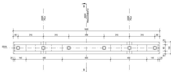
Figura 120 – Pila Tipo – Pianta pulvino e sezione fusto
