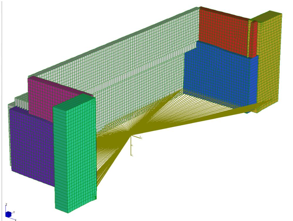
Figura 12: Modello con link - Vista tridimensionale fronte - Spalla 1
