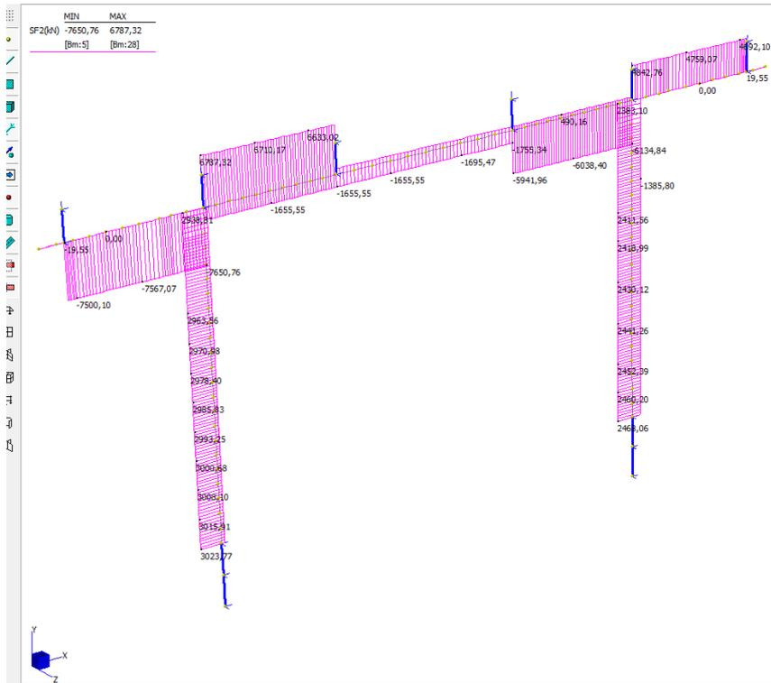
Figura 134 – Inviluppo diagramma dell'azione tagliante
