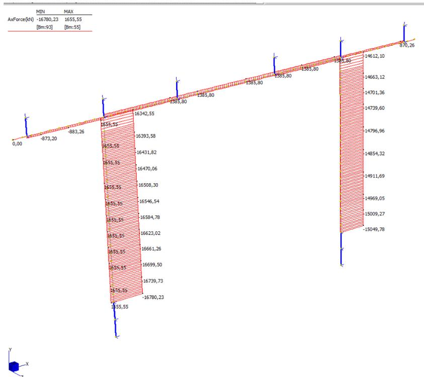
Figura 135 – Inviluppo diagramma dell'azione assiale
