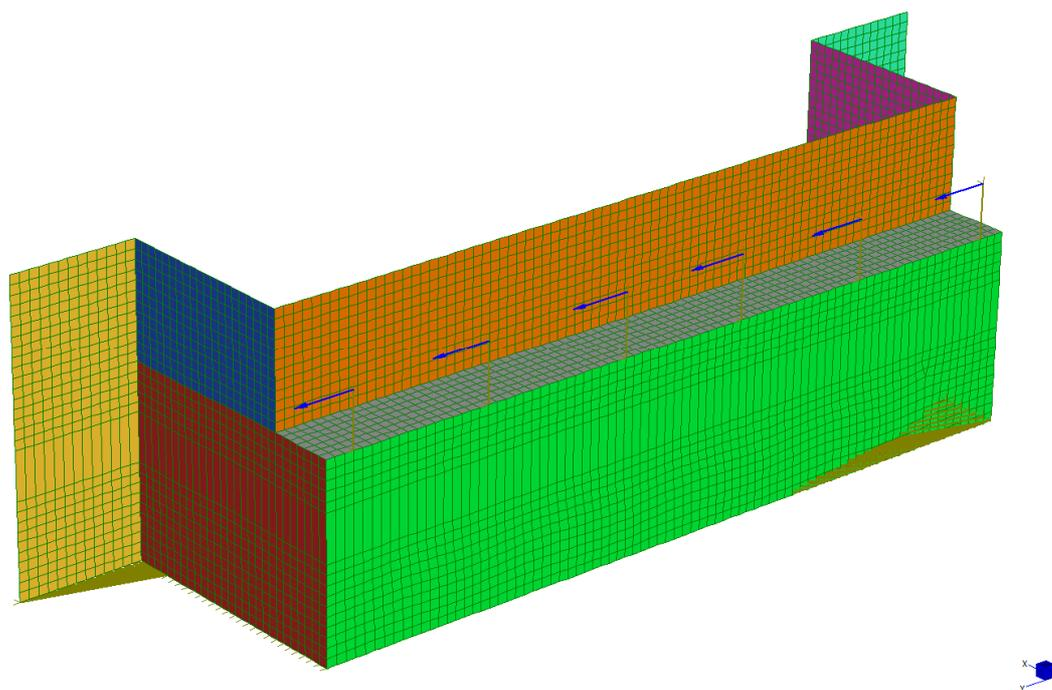
Figura 43: Azione trasversale sismica da impalcato
