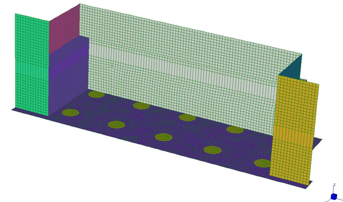
Figura 71: Modello agli elementi finiti per la determinazione delle sollecitazioni in platea
