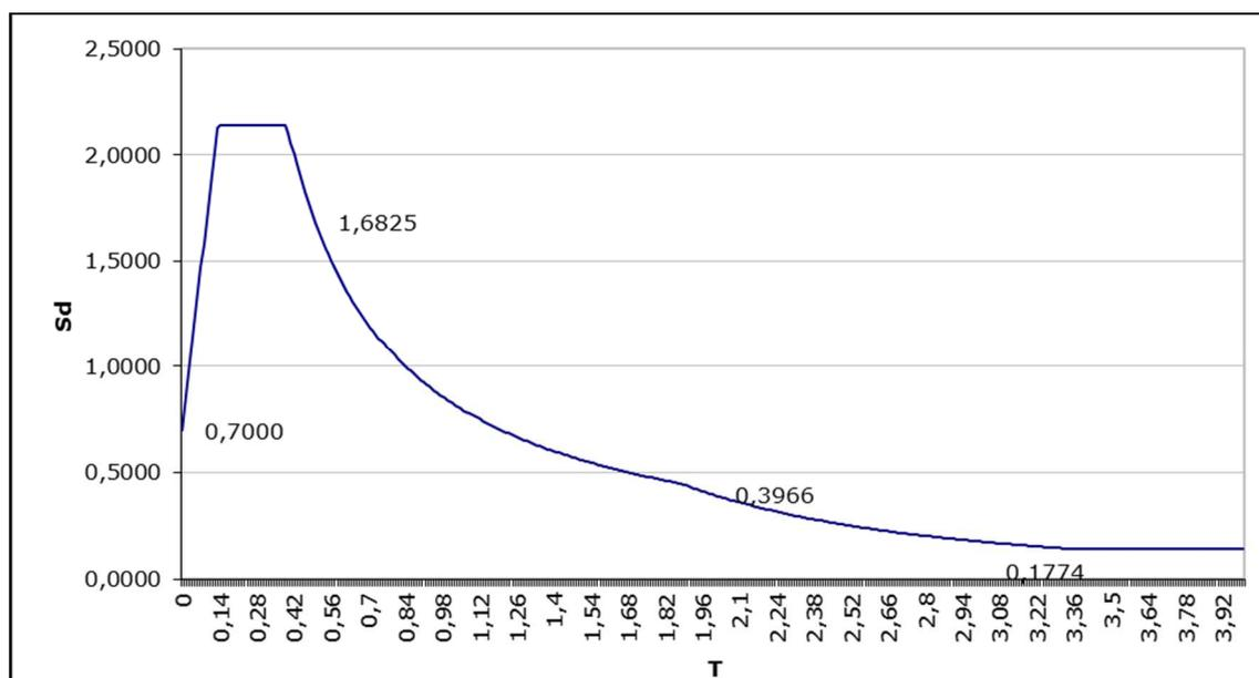
Figura 5 – Spettro di risposta allo SLV
