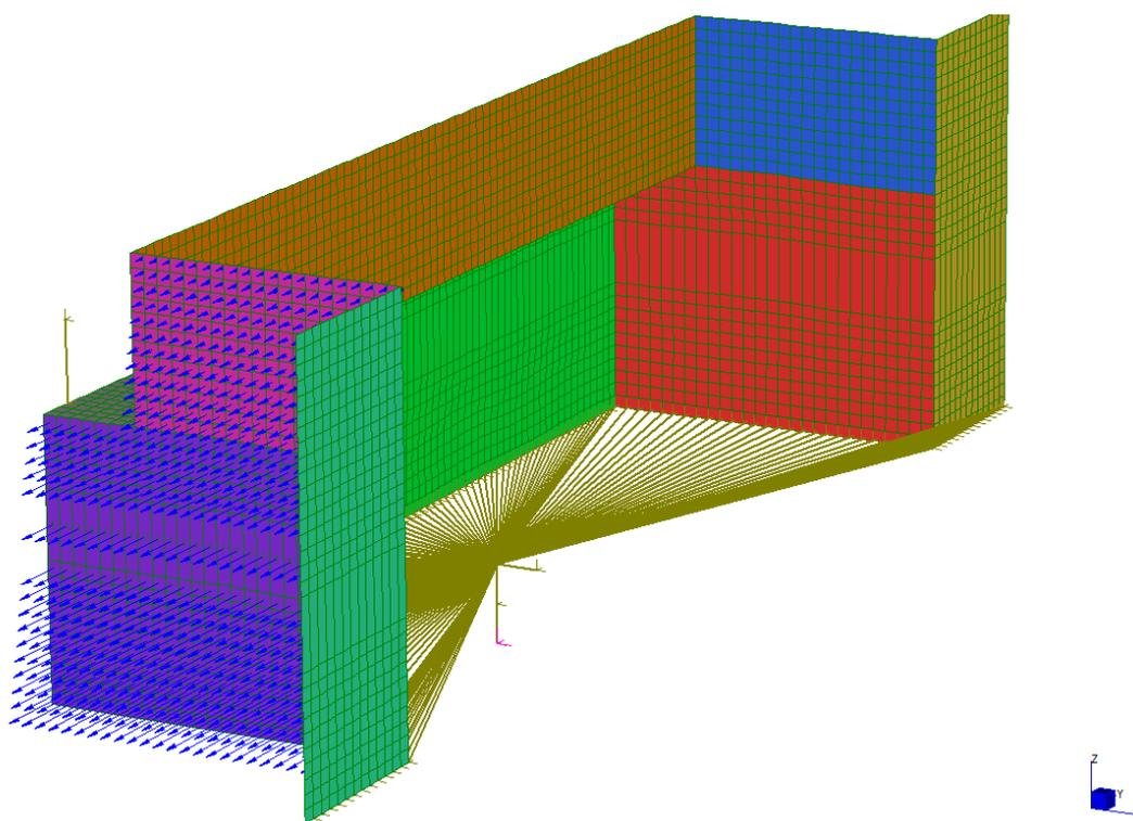
Figura 34: Spinta orizzontale del terreno direzione -Y
