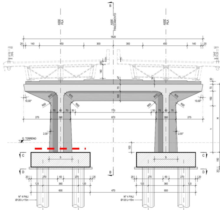
Figura 130 – Sezione di verifica del fusto della pila
