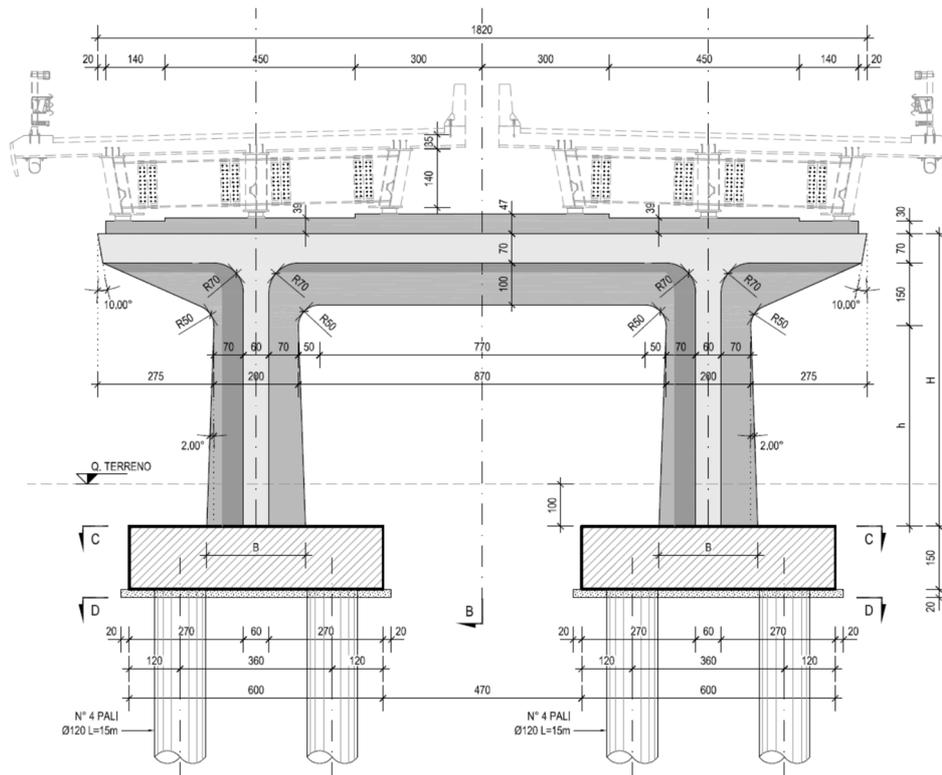
Figura 119 – Pila Tipo
