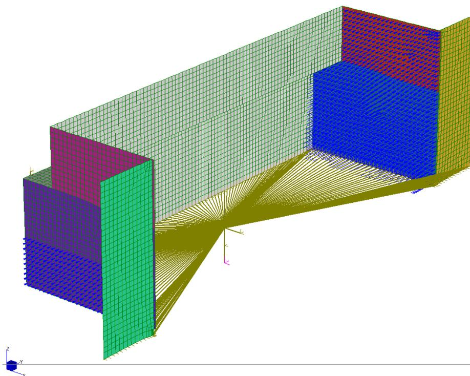
Figura 19: Spinta orizzontale del terreno direzione +Y
