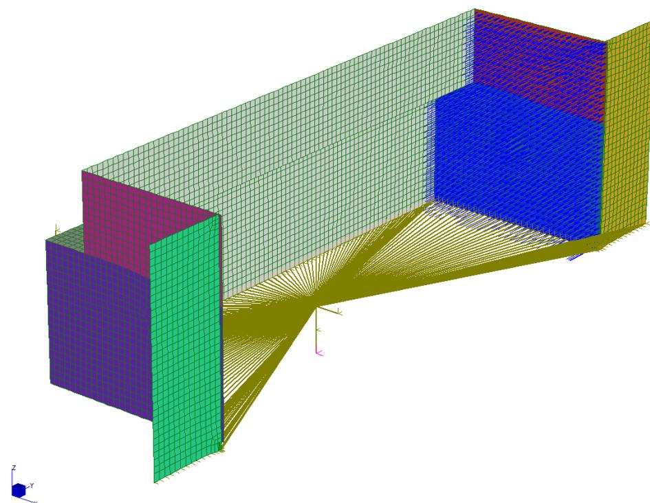
Figura 26: Sovrappinta sismica di Wood sui muri +Y
