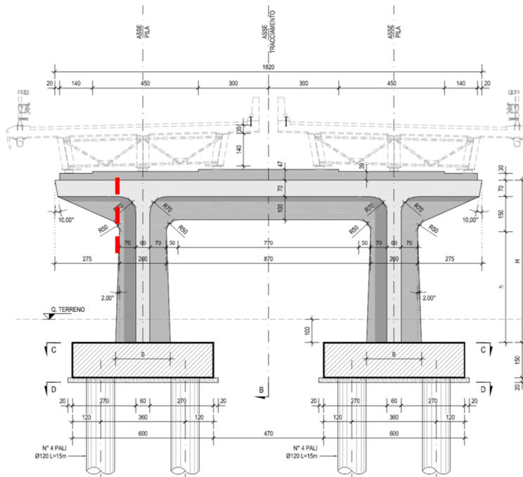
Figura 132 – Sezioni di verifica del traverso della pila
