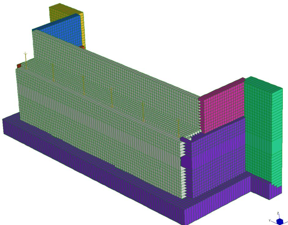
Figura 13: Modello con platea - Vista tridimensionale fronte - Spalla 2
