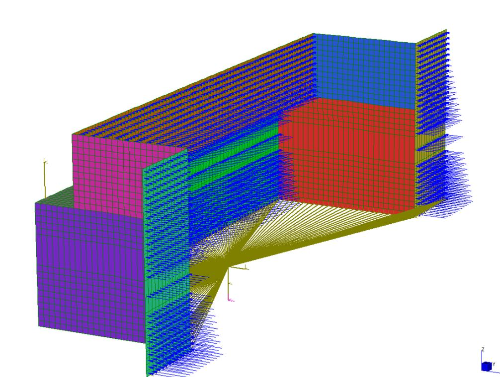
Figura 32: Spinta orizzontale del terreno direzione X
