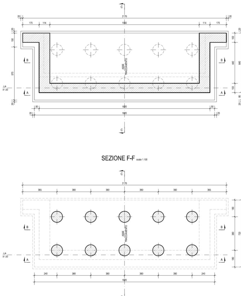
Figura 9: Sezione di carpenteria\_Spalla 2
