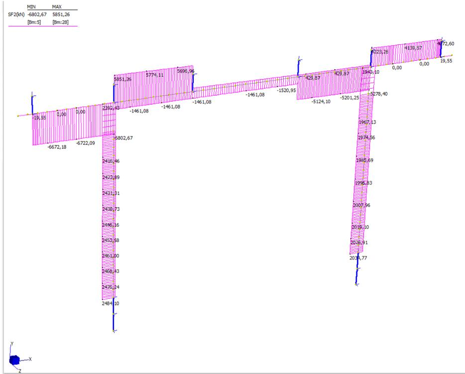
Figura 128 – Involuppo diagramma dell'azione tagliante
