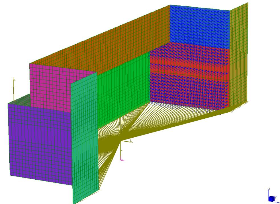
Figura 40: Sovrappinta sismica di Wood sui muri +Y
