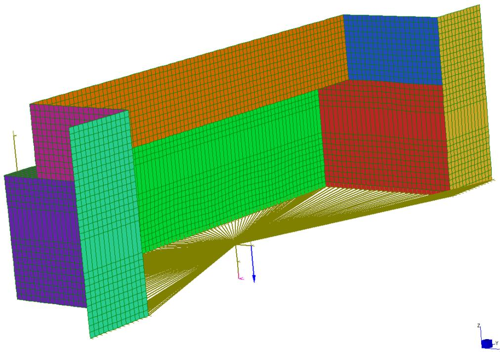
Figura 31: Peso del terreno di riempimento
