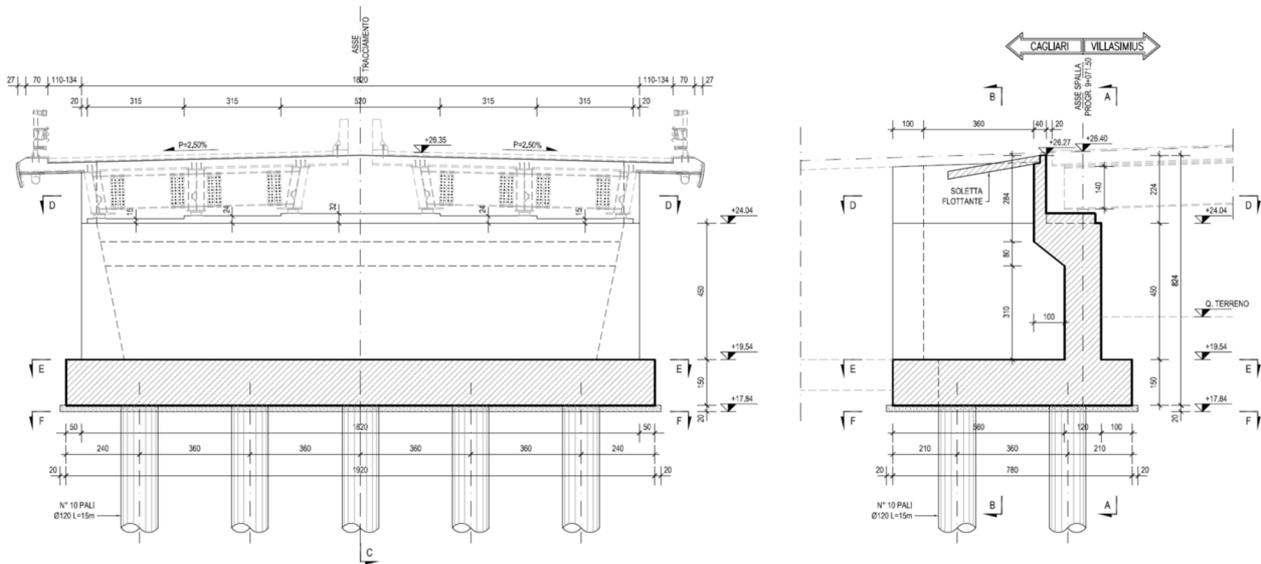
Figura 6: Sezione di carpenteria\_Spalla 1
