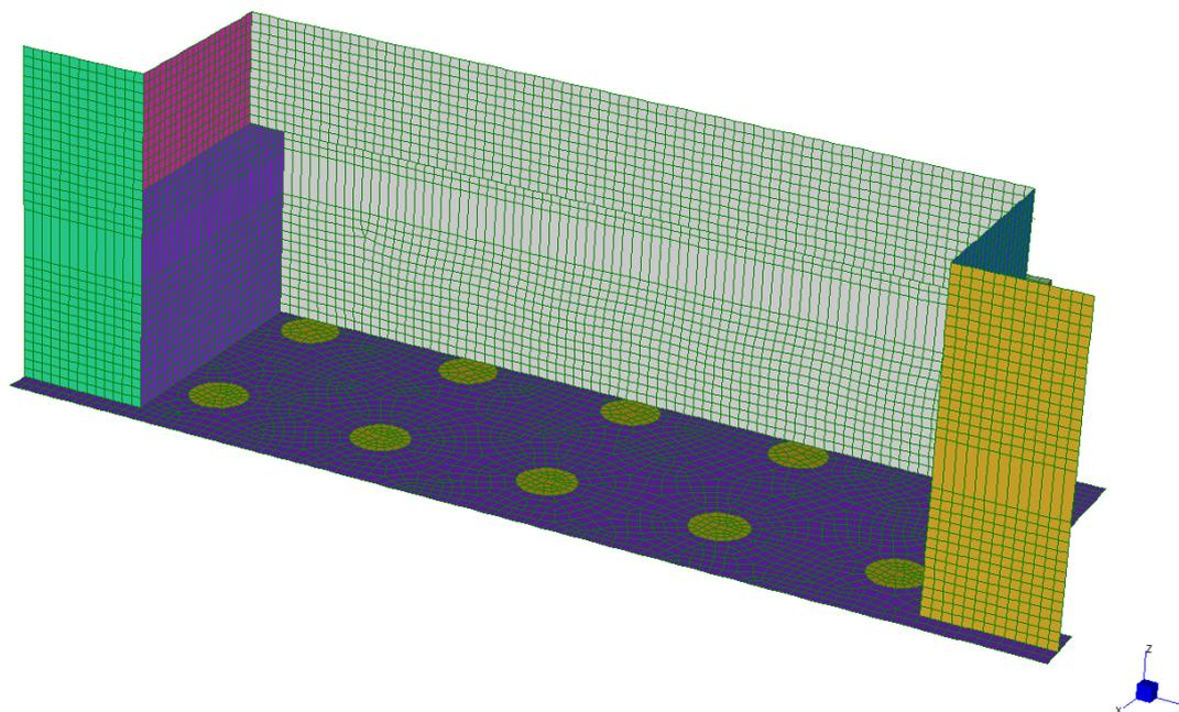
Figura 109: Modello agli elementi finiti per la determinazione delle sollecitazioni in platea
