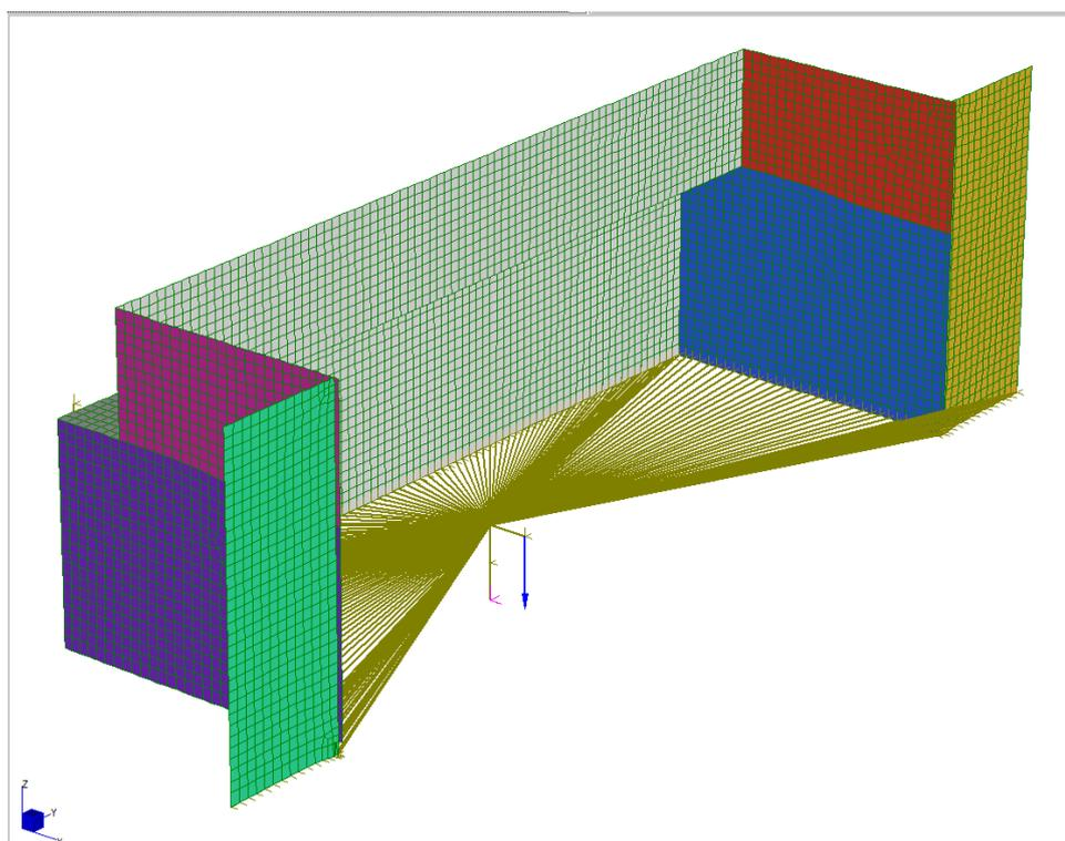
Figura 17: Peso del terreno di riempimento
