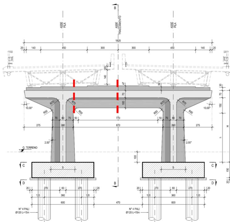
Figura 137 – Sezioni di verifica del traverso della pila
