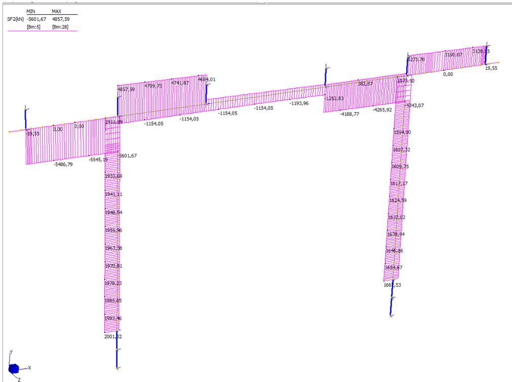
Figura 122 – Involuppo diagramma dell'azione tagliante
