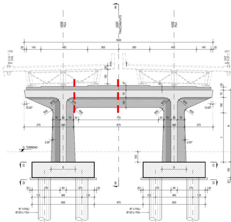
Figura 131 – Sezioni di verifica del traverso della pila
