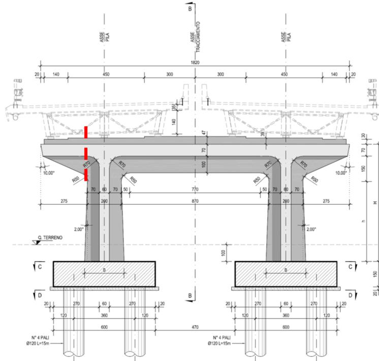
Figura 126 – Sezioni di verifica del traverso della pila
