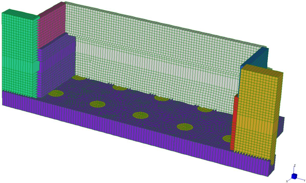
Figura 11: Modello con platea - Vista tridimensionale retro - Spalla 1
