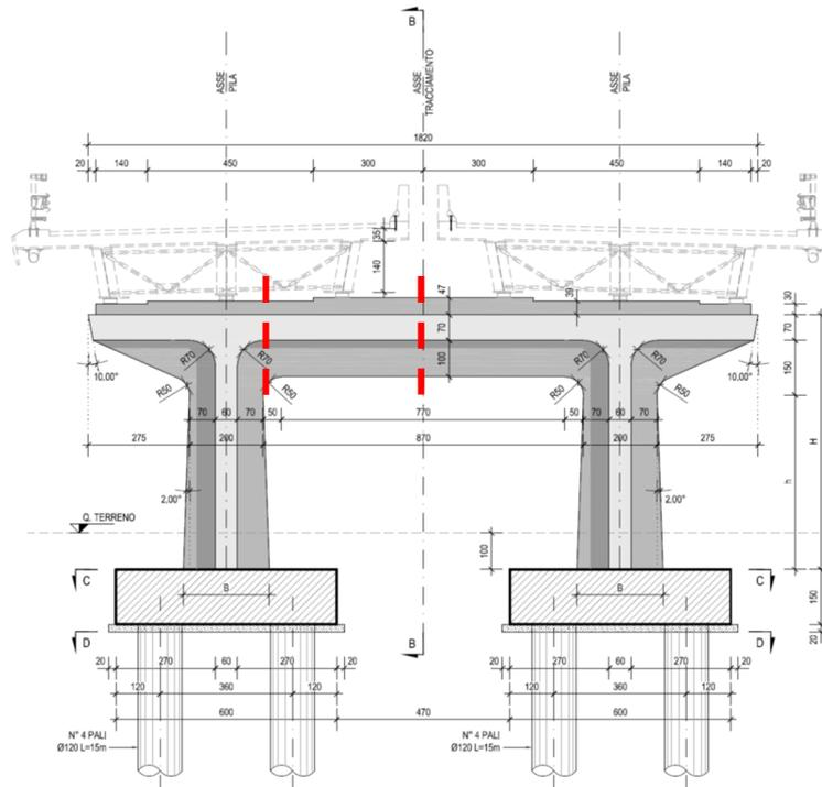
Figura 125 – Sezioni di verifica del traverso della pila
