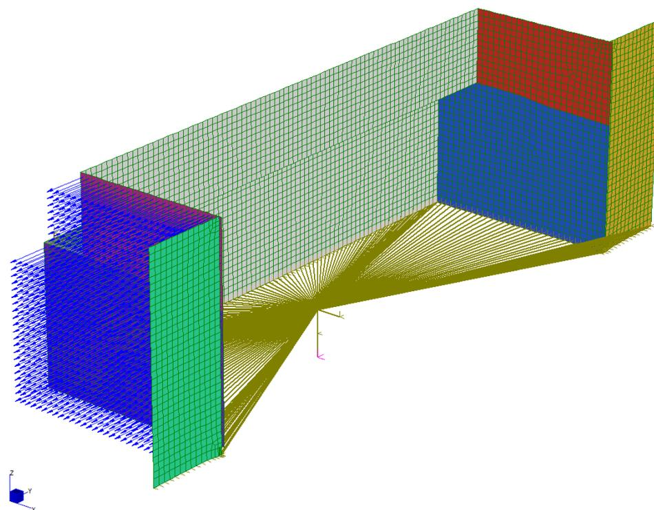
Figura 27: Sovrappinta sismica di Wood sui muri -Y
