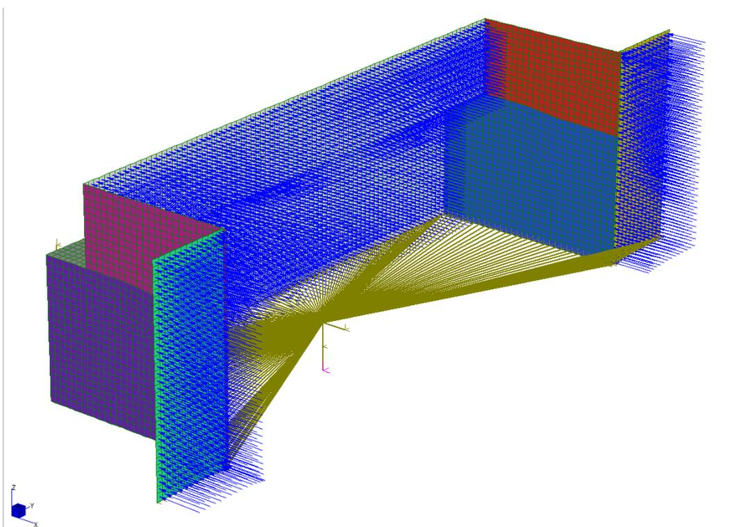
Figura 25: Sovrappinta sismica di Wood sul fusto
