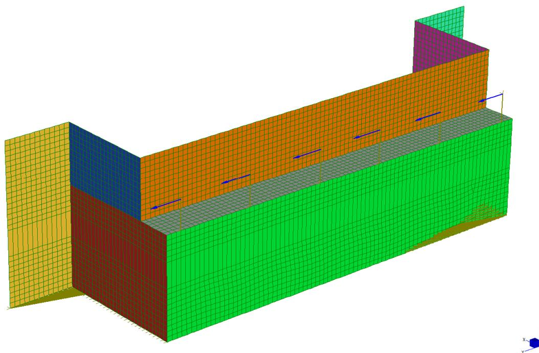
Figura 29: Azione trasversale sismica da impalcato
