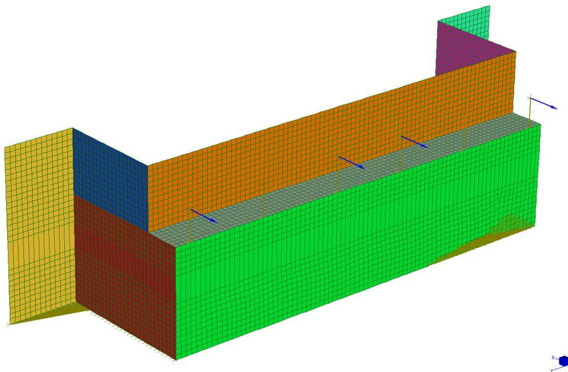
Figura 42: Azione orizzontale sismica da impalcato
