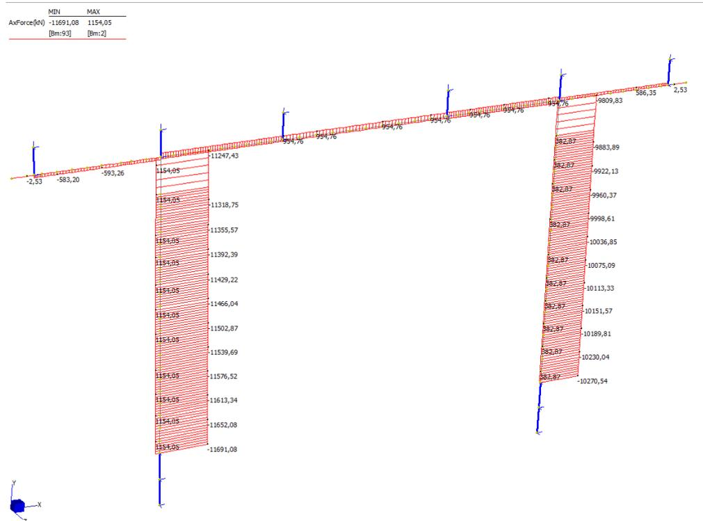
Figura 123 – Involuppo diagramma dell'azione assiale
