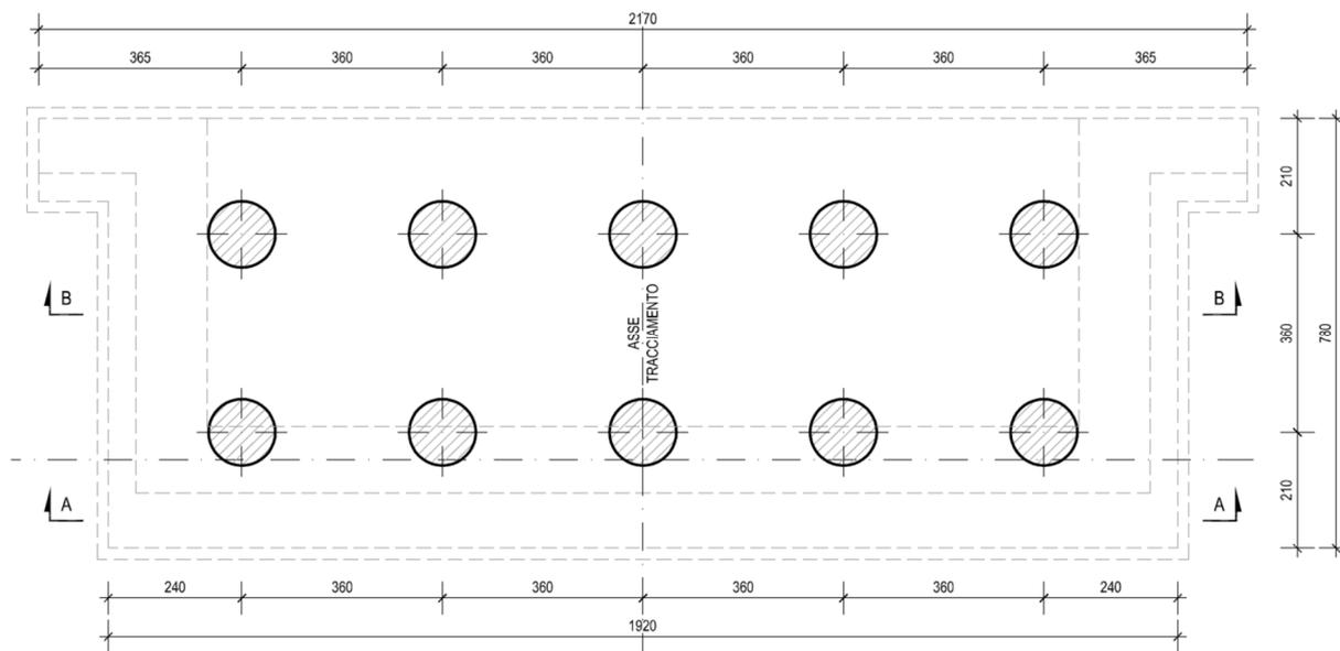
Figura 70: Pianta della platea di fondazione
