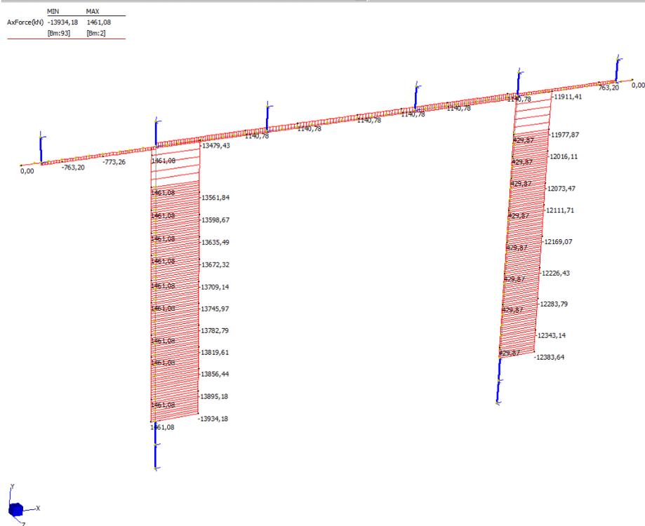
Figura 129 – Involuppo diagramma dell'azione assiale
