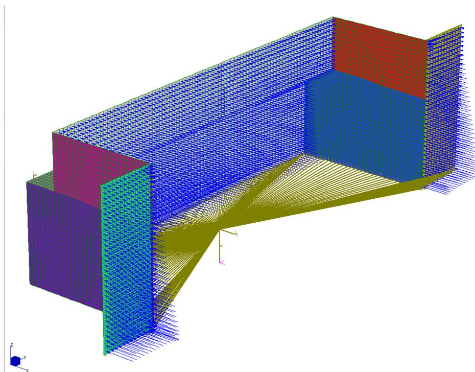
Figura 18: Spinta orizzontale del terreno direzione X
