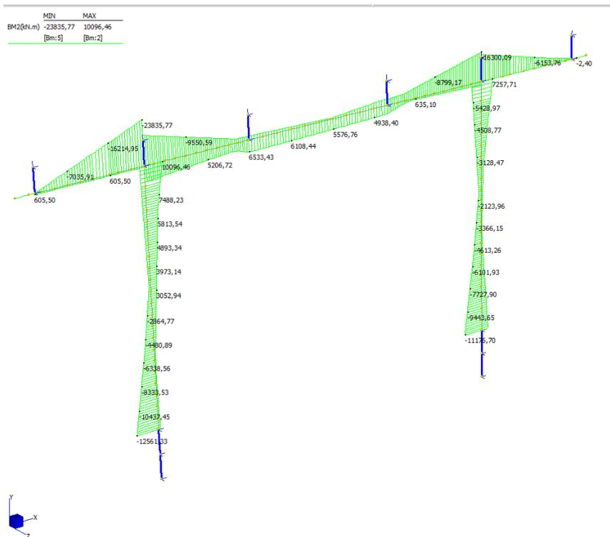
Figura 133 – Involuppo diagramma del momento flettente
