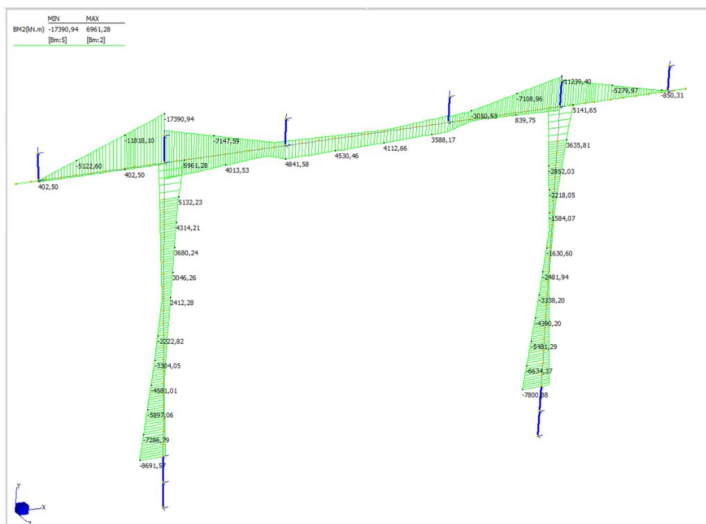
Figura 121 – Involuppo diagramma del momento flettente
