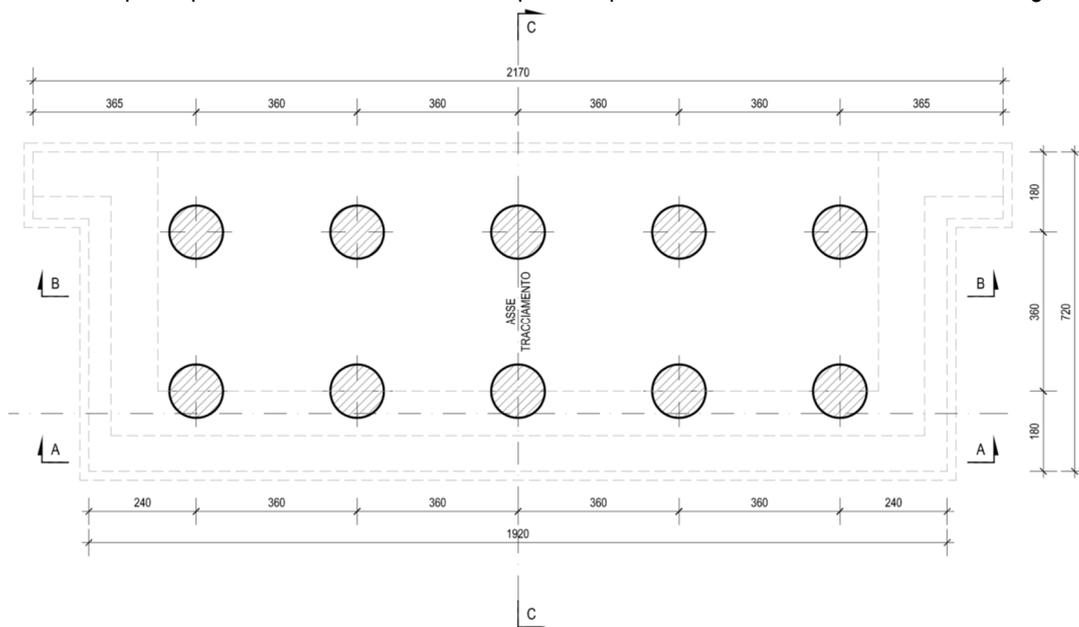
Figura 108: Pianta della platea di fondazione
