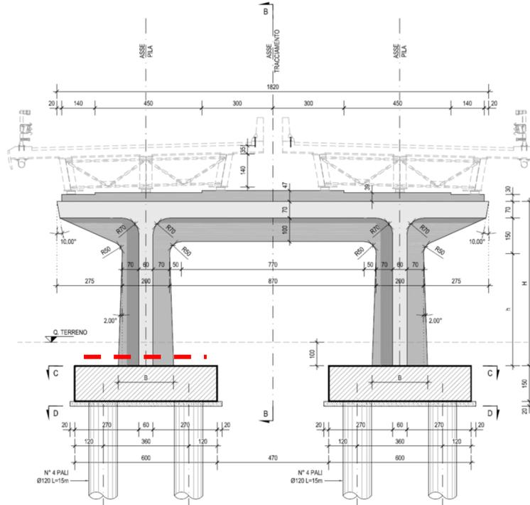
Figura 136 – Sezione di verifica del fusto della pila
