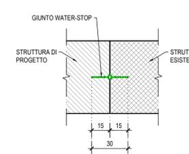
DETTAGLIO GIUNTO DI SOTTOPAVIMENTAZIONE
