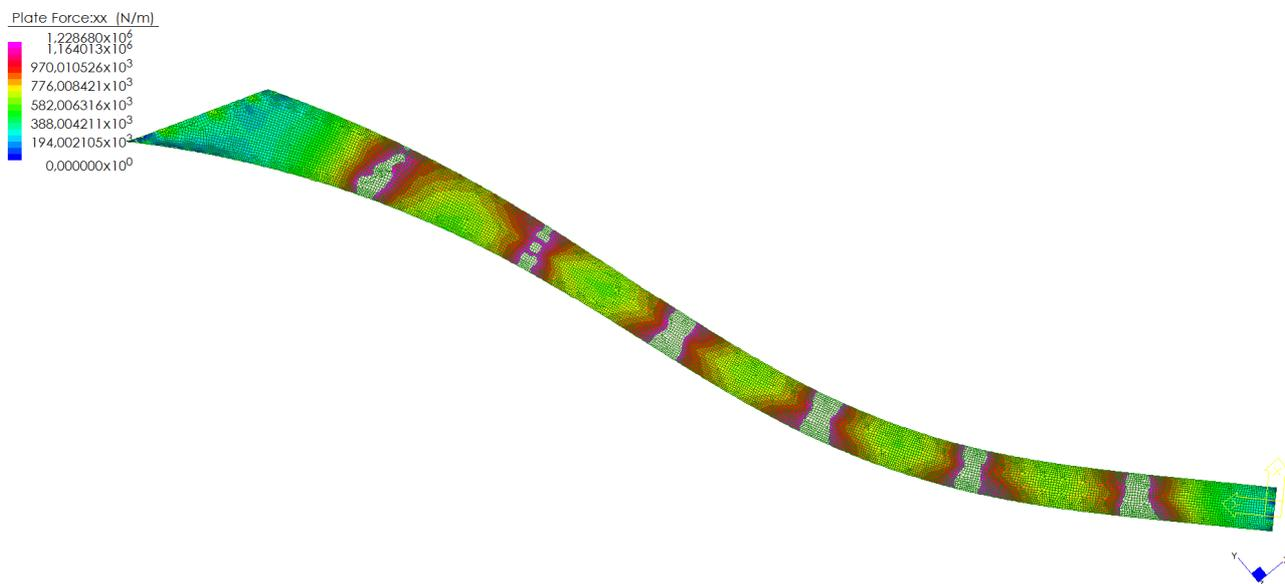
Si infittisce la soletta in corrispondenza degli appoggi 2, 3, 4, 5 con spezzoni di armature 1φ14/20 superiori ed inferiori di lunghezza 10m. Tale infittimento di armatura porta la resistenza a trazione della sezione a:
