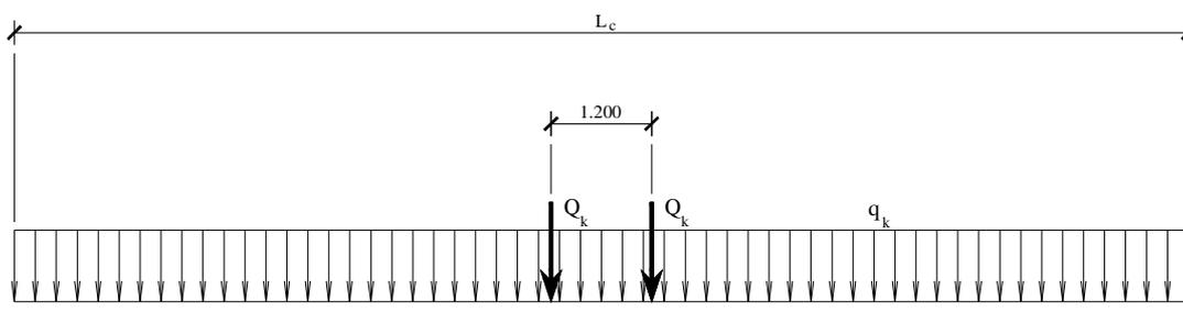
fig. 5.3 – Schema generale della disposizione longitudinale di carico
