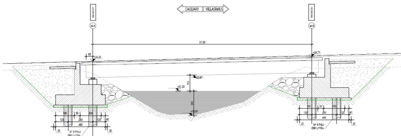
Le spalle sono costituite da una struttura in calcestruzzo armato di lunghezza 11.30 e altezza massima 4.10m. La fondazione, una platea di spessore 1.0m e dimensioni 11.3x4.80m, è appoggiata su 6 pali di diametro 0.8m posti ad interasse di 2.40x3.90m. In questo caso, per ragioni esecutive di getto, il fusto si fonde con il paraghiaia generando un blocco in calcestruzzo pieno di dimensioni 2.6x1.0m
