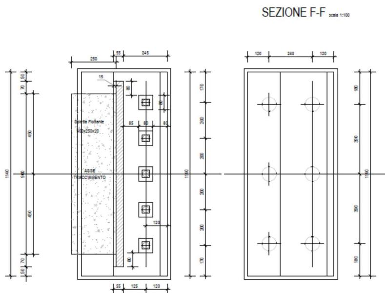
Figura 16: Pianta carpenteria - Spalla tipo
