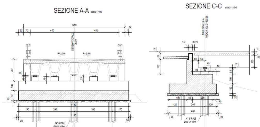
Figura 15: Sezione di carpenteria - Spalla tipo
