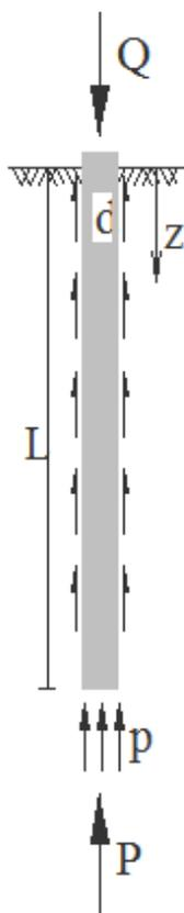
Figura 30 – Carico limite palo  $Q_{lim} = P + S$
