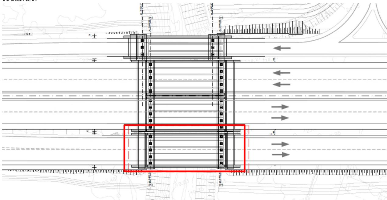
L'impalcato dei ponti presenta andamento rettilineo e si sviluppa su di una campata unica di lunghezza pari a circa 21.20m. La sezione trasversale ha larghezza di 10.40m con una pavimentazione larga 9.0m. La struttura portante è costituita da 5 travi in calcestruzzo armato precompresso di altezza pari a 1.25m con soletta collaborante di spessore 28.0cm.
