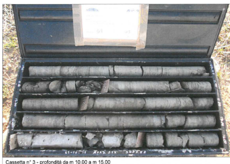
Figura 9 – Casette catalogatrici sondaggio S3DH (prof. 0-15m)
