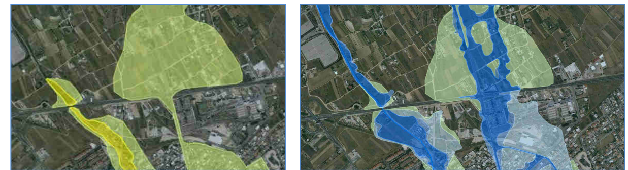
Figura 28 - A sinistra area a rischio di piena nel bacino del Riu Saliu e del Riu Mortu; a destra le aree di pericolo di piena individuate, a norma dell'art. 8, c.2, delle Norme di attuazione del PAI, negli strumenti urbanistici comunali. (Fonte: Sardegna Geoportale, Sardegna Mappe PAI).
