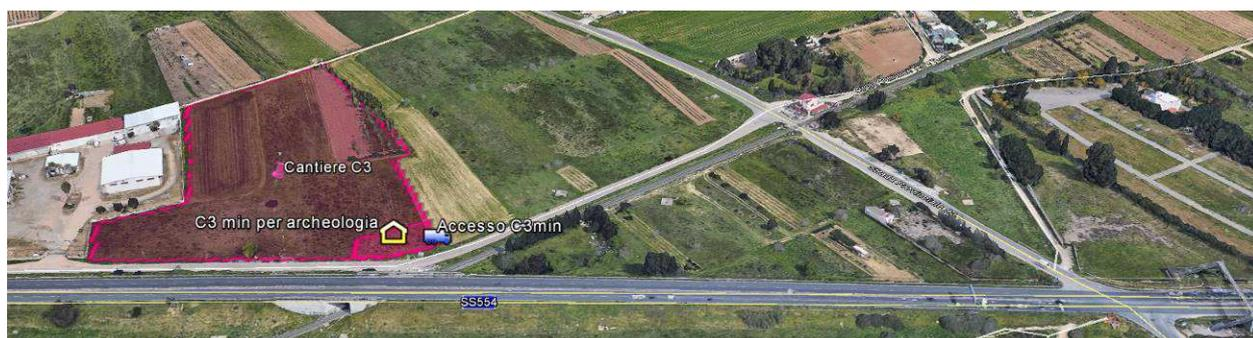
L'area logistica di cantiere prevede il posizionamento dei servizi logistici (ufficio, spogliatoio, servizio igienico), la creazione di una piccola area di parcheggio automezzi ed una ridotta zona di stoccaggio dei materiali, container.
