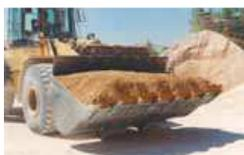
Trattasi della formazione di rilevati, per realizzazione di nuova viabilità, sottofondi dei parcheggi o riempimenti e reinterri delle aree di cantiere, la cui realizzazione comporta sempre la movimentazione di ingenti quantitativi di terreno (necessariamente di buona qualità), eseguita mediante mezzi meccanici. In particolare si prevedono le seguenti attività:
