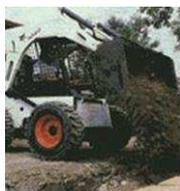
Trattasi del rinterro di scavi con materiale proveniente dallo scavo e depositato in cantiere, compresi il carico, il trasporto, lo scarico e lo stendimento, nonché l'onere per il costipamento del materiale di rinterro o riporto, eseguito con mezzi meccanici. Per rinterri si intende:
