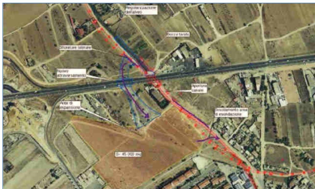
Figura 17 - Corografia degli interventi per la mitigazione dell'impatto dell'opera sui deflussi del Rio Saliu (Fonte: Studio di approfondimento conoscitivo, analisi e modellazione idrologica e idraulica delle principali interferenze con i deflussi superficiali delle opere previste nel progetto preliminare della "SS 554 Cagliariitana" (CINSA).
