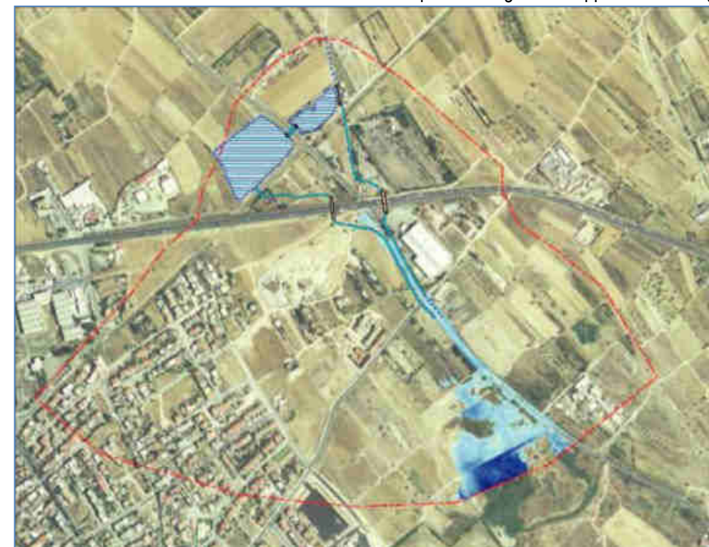
Figura 20 - Ubicazione delle vasche di laminazione e aree esondabili nel bacino San Lussoriu con Tr=200 anni (Fonte: Studio di approfondimento conoscitivo, analisi e modellazione idrologica e idraulica delle principali interferenze con i deflussi superficiali delle opere previste nel progetto preliminare della “SS 554 Cagliaritana” Tav. 7.2.B (CINSA).
