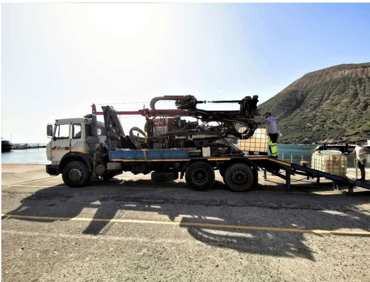
Figura 4 – Fasi della mobilitazione della sonda perforatrice oleodinamica, del personale e delle attrezzature.
