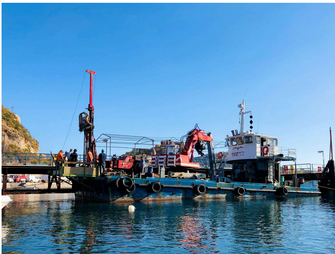
Figura 7 – Motopontone Albatros impiegato per le attività di carotaggio, ormeggiato in banchina al porto di Vulcano.
