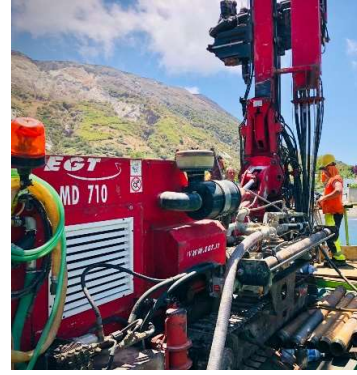
Figura 6 – Caratteristiche tecniche della sonda perforatrice oleodinamica a rotazione “EGT MD 710”.
