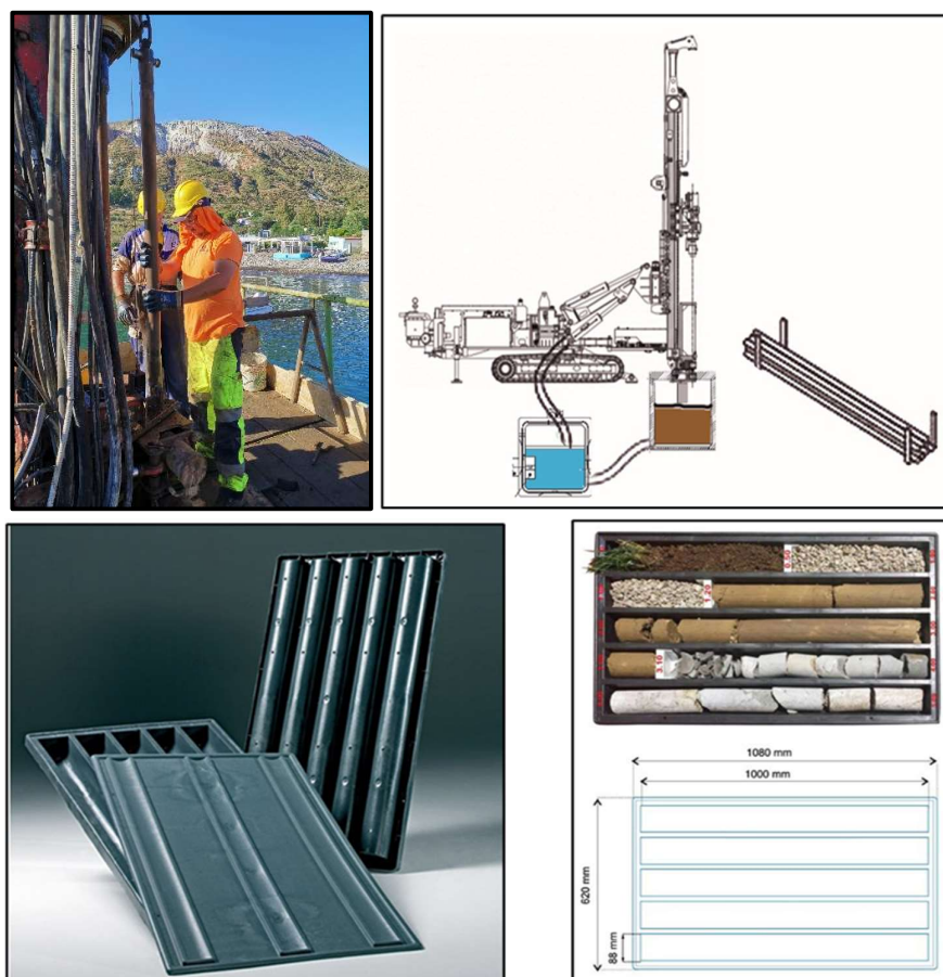
Figura 9 – Schema generale del sistema di perforazione a carotaggio continuo con a corredo le apposite cassette catalogatrici in pvc
