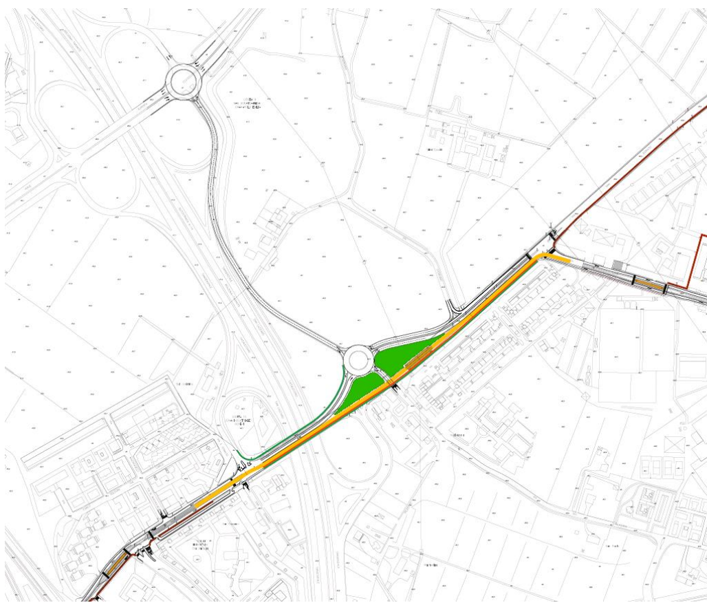
Figura 6 - Planimetria soluzione proposta dal Comune: chiusura totale svincolo 9 e realizzazione nuova bretella
