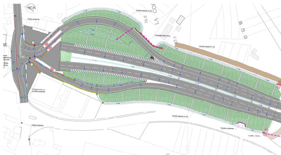
Figura 36: Planimetria smaltimento acque di progetto
