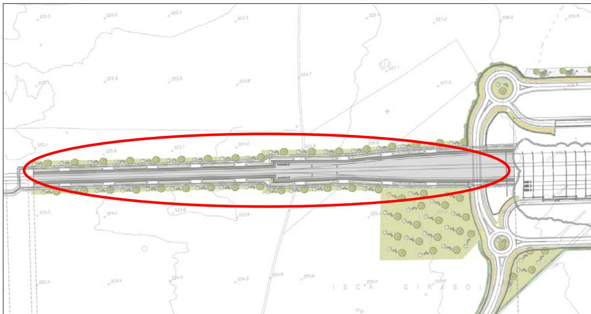
**Figura 5-4 – Stralcio planimetrico con l'individuazione delle opere a verde di mitigazione**
