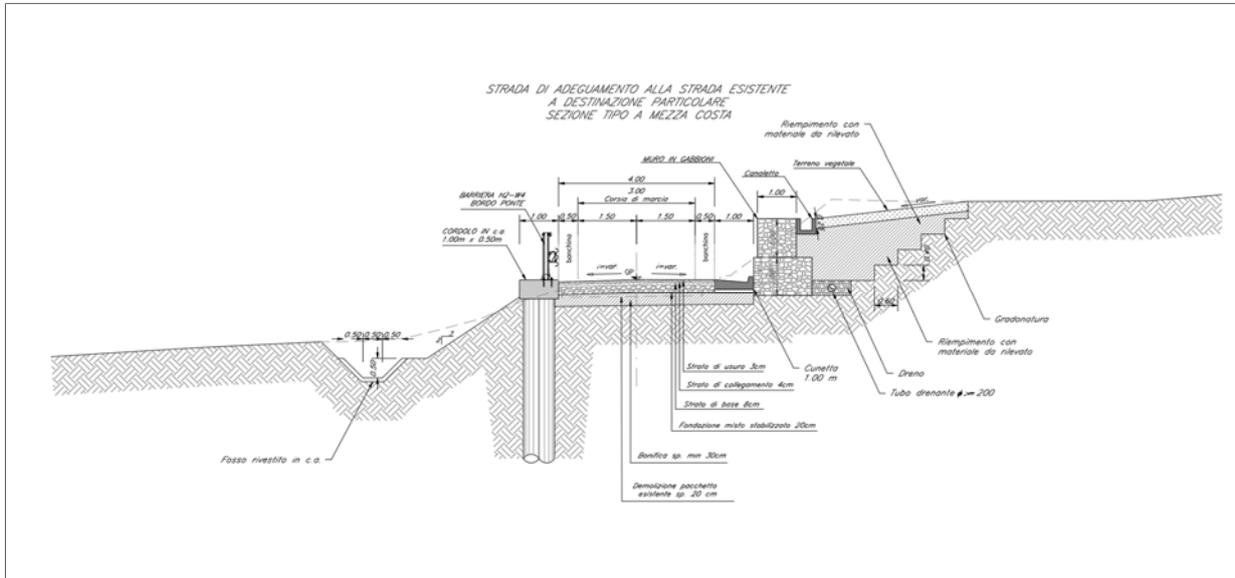
Figura 5.2 – Sezione tipologica a due gabbioni (H<sub>tot</sub> 2m) NV05a
