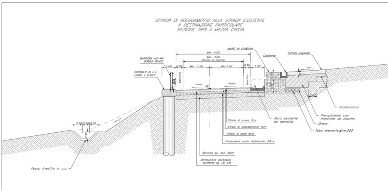
Figura 5.3 – Sezione tipologica a due gabbioni (H<sub>tot</sub> 1.5m) NV05a
