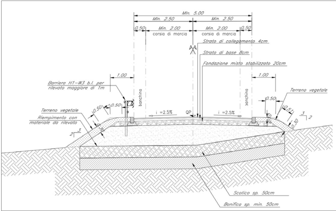
Figura 5.12 – Sezione tipologica in rilevato NV05dp
