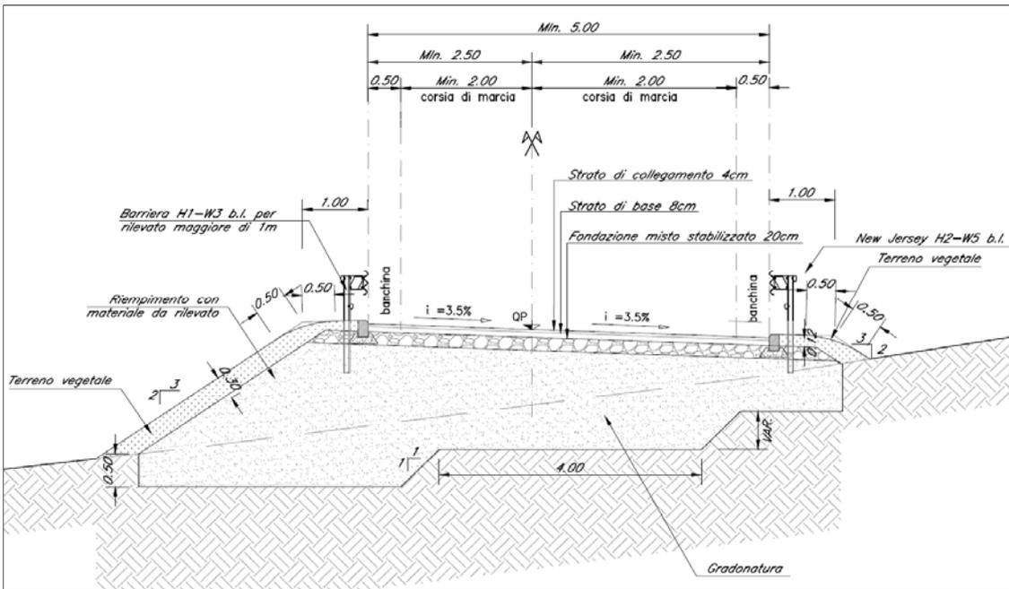
Figura 5.13 – Sezione tipologica in rilevato (curva) NV05dp
