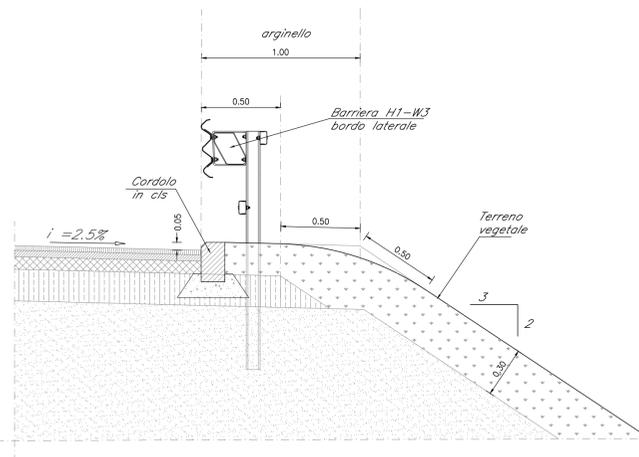
PARTICOLARE GRADONATURA IN AMMORSAMENTO A SCARPATA ESISTENTE
