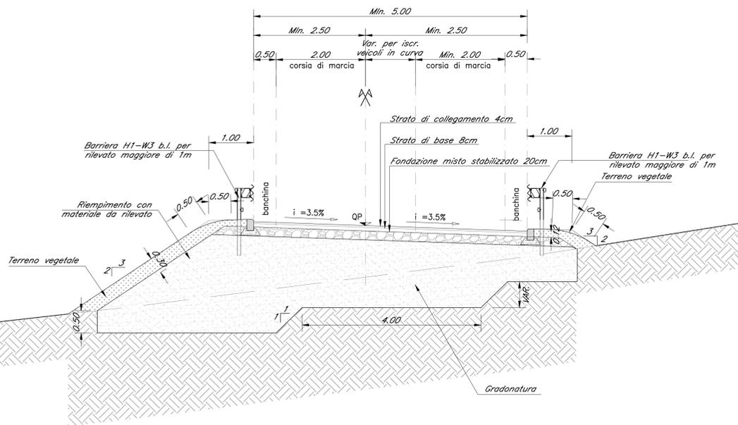
PARTICOLARE COSTRUTTIVO ARGINELLO CON BARRIERA METALLICA
