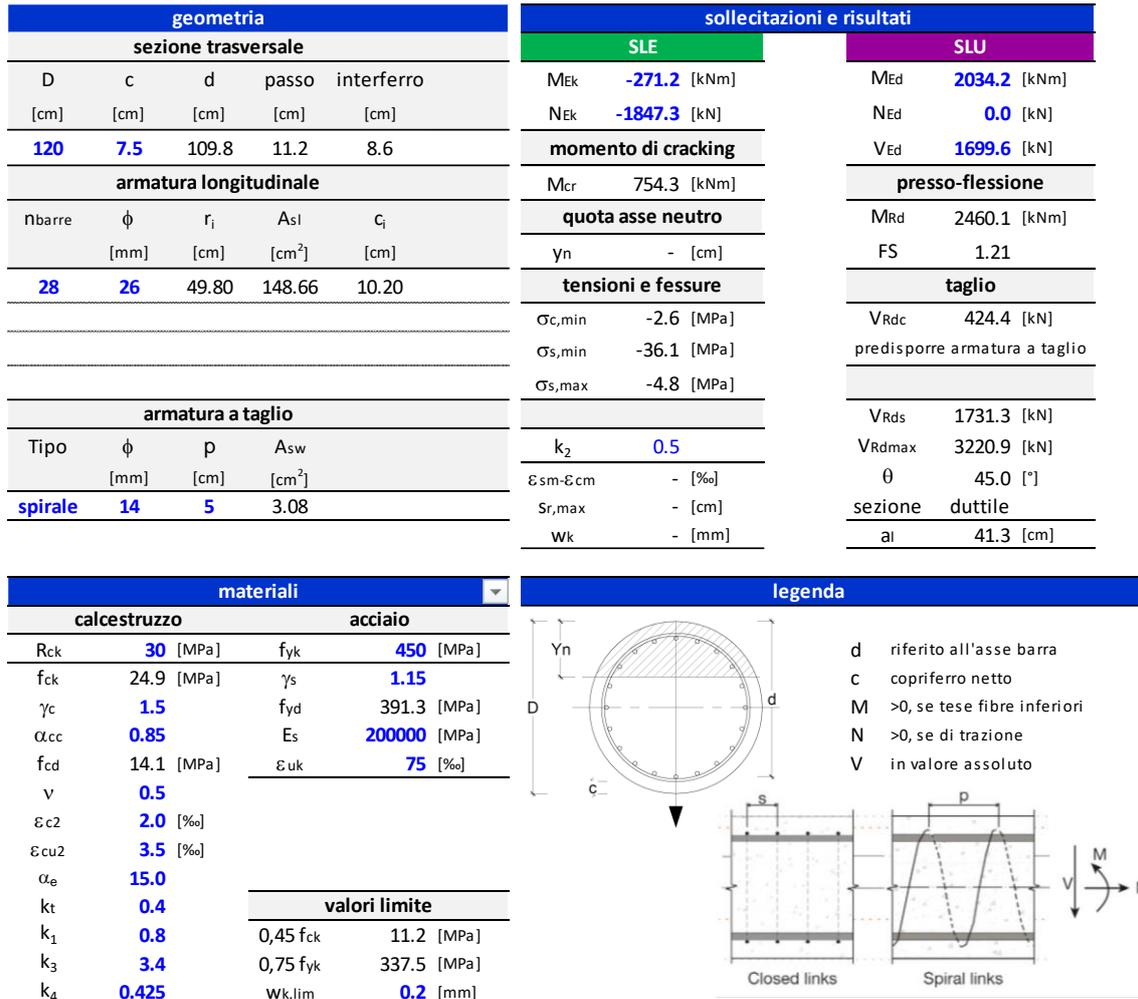
Figura 13.5. Verifiche allo SLU ed allo SLE di tipo STR pali di fondazione.
