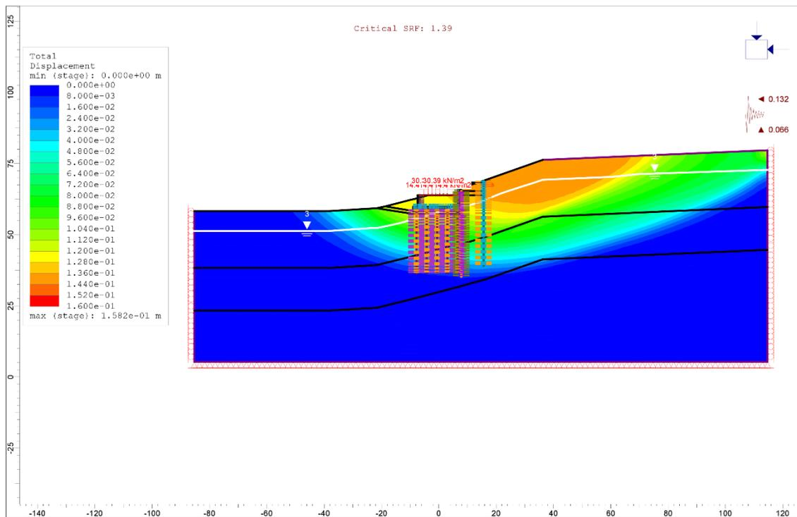
Figura 11.18. Sezione 3-3: analisi di stabilità in presenza dell'azione sismica.
