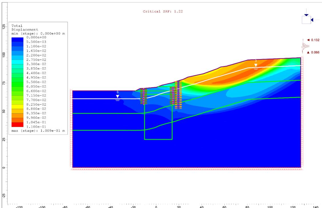
Figura 9.12. Fase 6: analisi di stabilità in presenza dell'azione sismica.
