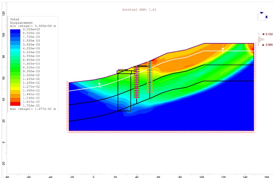
Figura 11.19. Sezione 4-4: analisi di stabilità in presenza dell'azione sismica.
