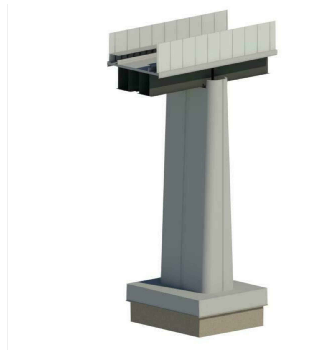
VISTA ASSONOMETRICA IMPALCATO IN ACCIAIO LUCE 65 m
