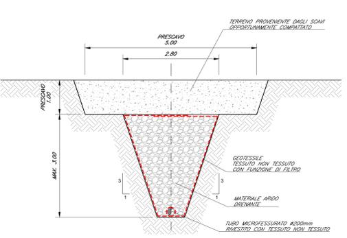
SEZIONE TIPO TRINCEA DRENANTE CON FOSSO RIVESTITO
