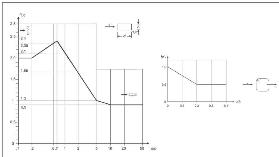
Figura 6.12 – Determinazione del coefficiente di forma  $c_{f,0}$  in funzione delle dimensioni della sezione (fig. 7.23 EC1-4) e correlazione tra il raggio di arrotondamento dello spigolo e il fattore riduttivo  $\psi_r$  (fig. 7.24 EC1-4)
