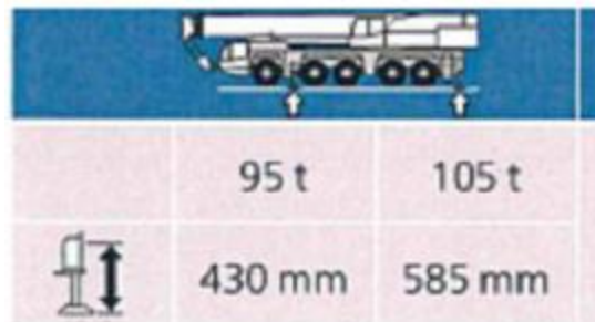
Figura 10.35. Esempio condizione di carico di un mezzo pesante di cantiere
