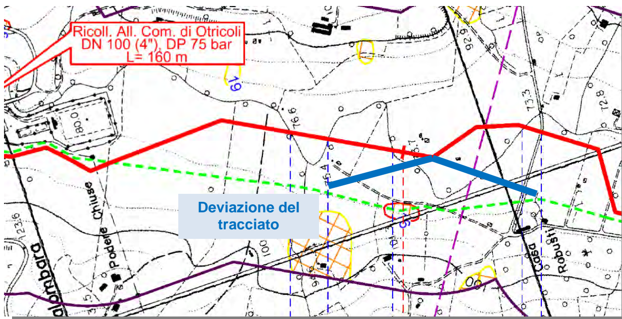
Fig. 15 - Piano di assetto idrogeologico - Inventario fenomeni franosi: foglio 27 elaborato 90-DT-D-5206: ipotesi di deviazione del tracciato (linea blu)
