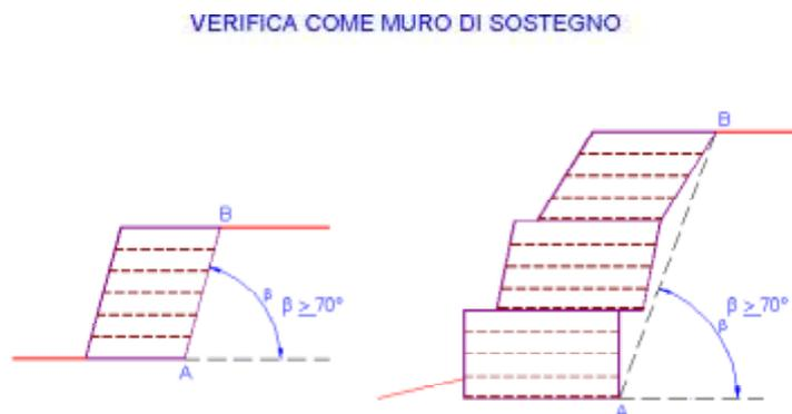
La valutazione della pendenza media viene effettuata dal programma considerando la retta congiungente lo spigolo inferiore destro del primo blocco (Figura 9.11, punti A) con lo spigolo superiore destro dell'ultimo blocco di verifica (Figura 9.11, punti B)
