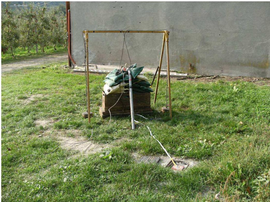
**Figura 5** – Il dispositivo di energizzazione utilizzato per la prova down-hole.
