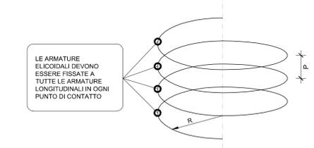
LE ARMATURE ELICOIDALI DEVONO ESSERE FISSATE A TUTTE LE ARMATURE LONGITUDINALI IN OGNI PUNTO DI CONTATTO
