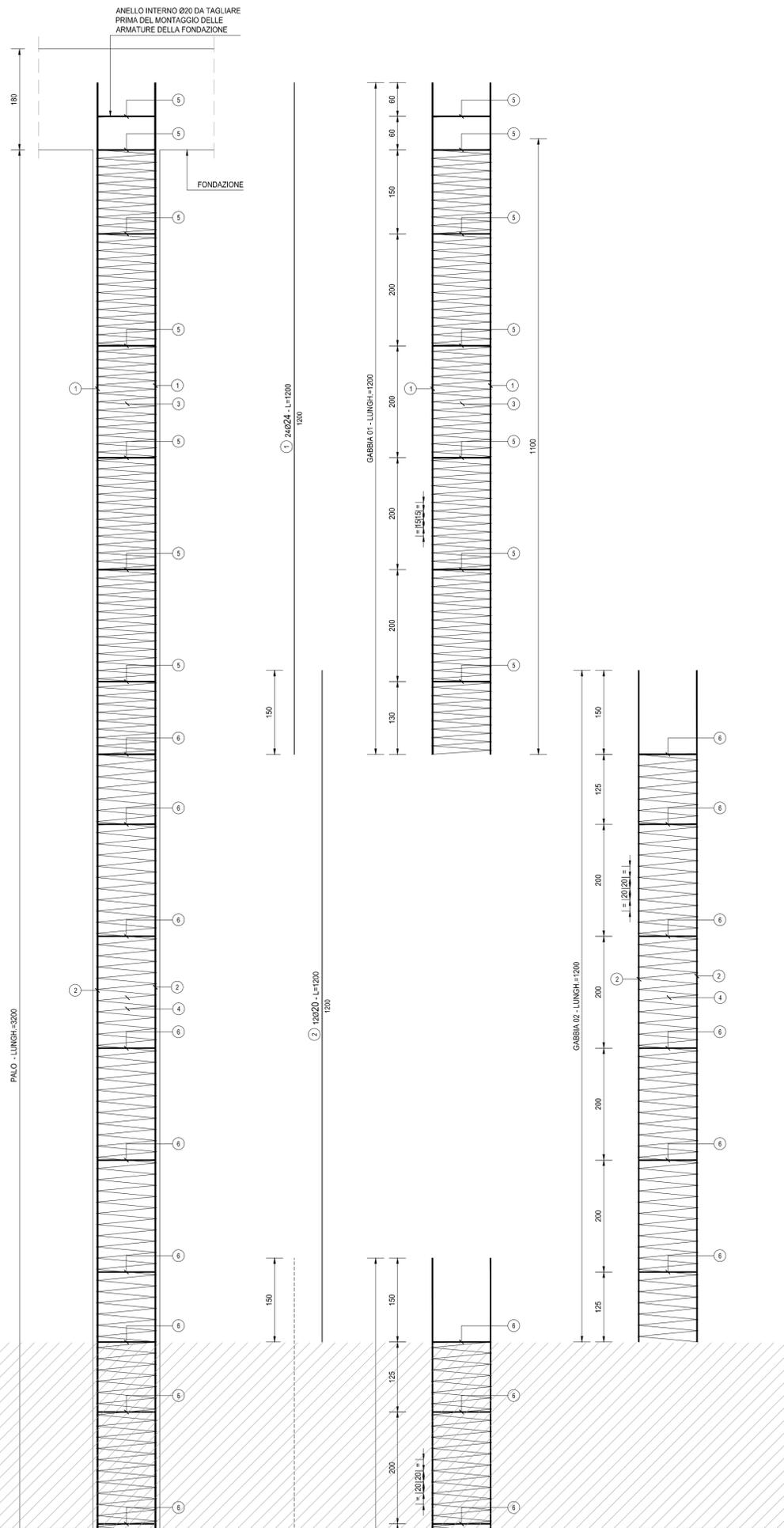
SEZIONE LONGITUDINALE DEL PALO (2 di 2)
