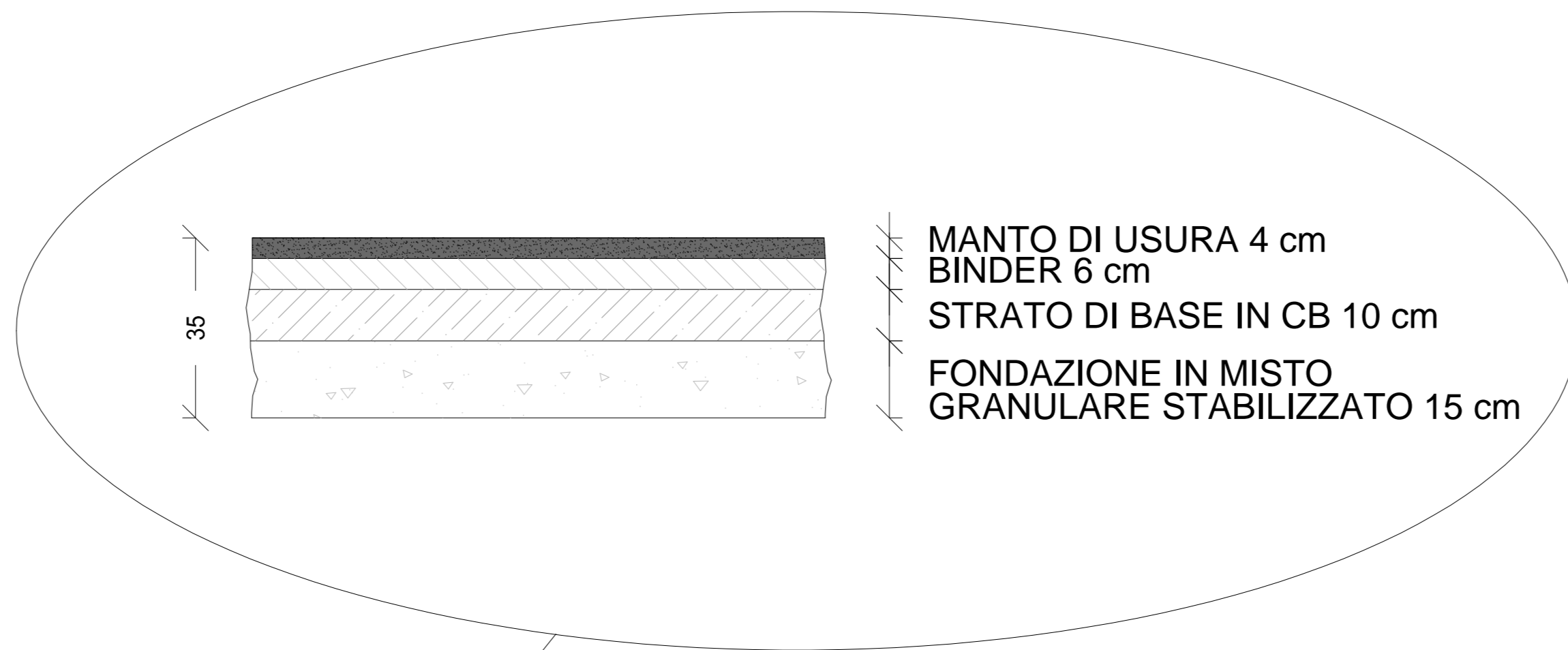
PARTICOLARE PAVIMENTAZIONE STRADALE scala 1:10
