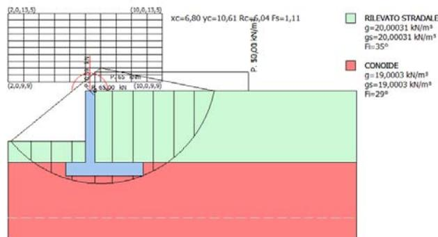
Fig. 8b\_ Modello di calcolo per verifica di stabilità
