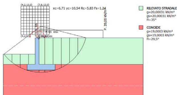
Fig. 7b Modello di calcolo per analisi di stabilità
