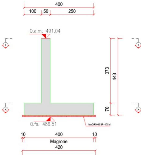
Fig. 2\_a Sezione trasversale concio n. 4
