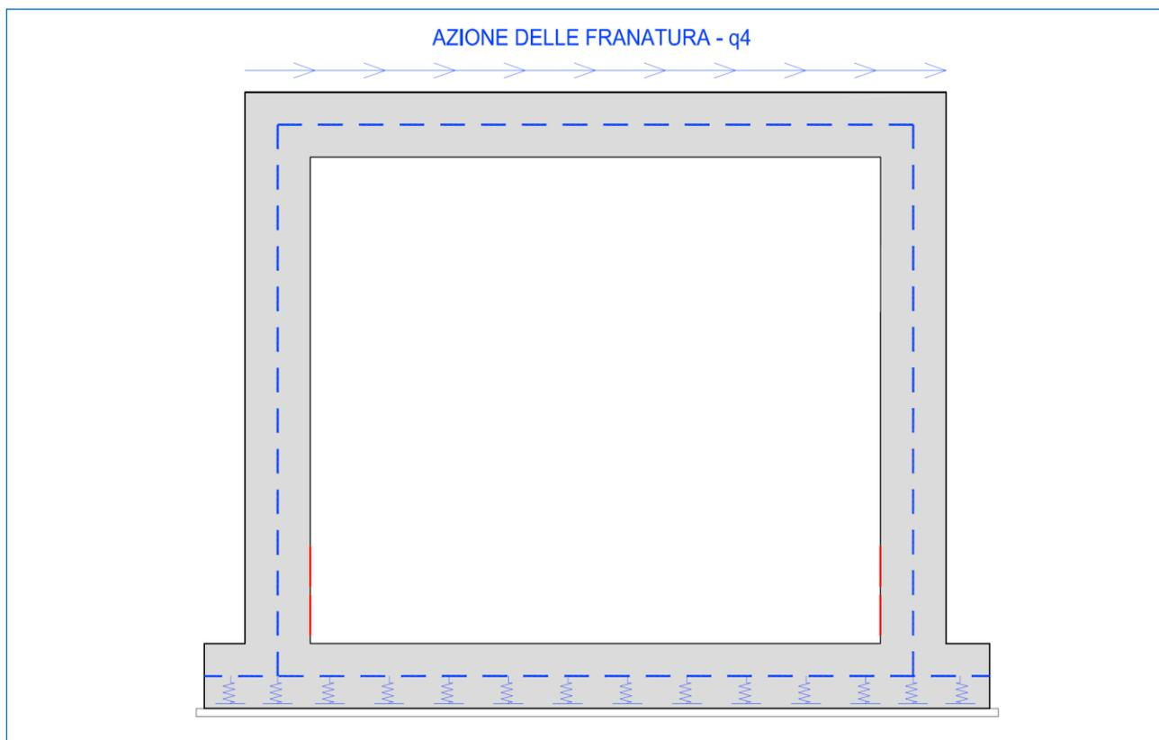
Il carico applicato tiene conto delle maggiori dimensioni reali dello scatolare rispetto a quelle del modello ad elementi beam.
