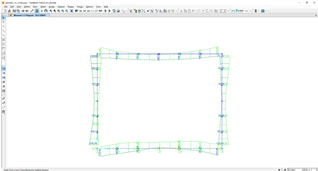
Nel diagramma successivo è riportato l'andamento dell'azione tagliante per la combinazione di involuppo delle combinazioni di carico allo SLU – STR:
