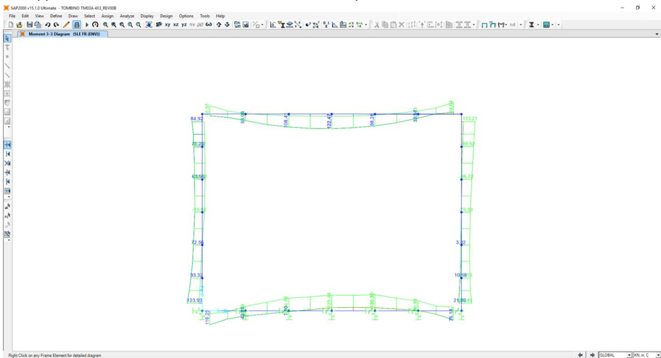
Nel diagramma successivo è riportato l'andamento dell'azione tagliante per la combinazione di involuppo delle combinazioni di carico allo SLE – Frequenti:
