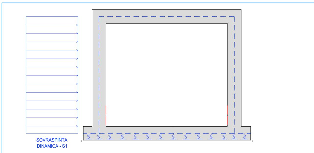
Nota Bene: l'azione sismica è applicata ad un solo lato del modello (alla stregua di quanto già fatto per le spinte del terreno in condizione k0/ka e delle sovraspinte). L'output del modello, in termini di sollecitazioni flettenti e taglianti, è quindi di tipo asimmetrico. L'armatura è ovviamente stata progettata simmetrica e le verifiche sono state condotte con i valori massimi.
