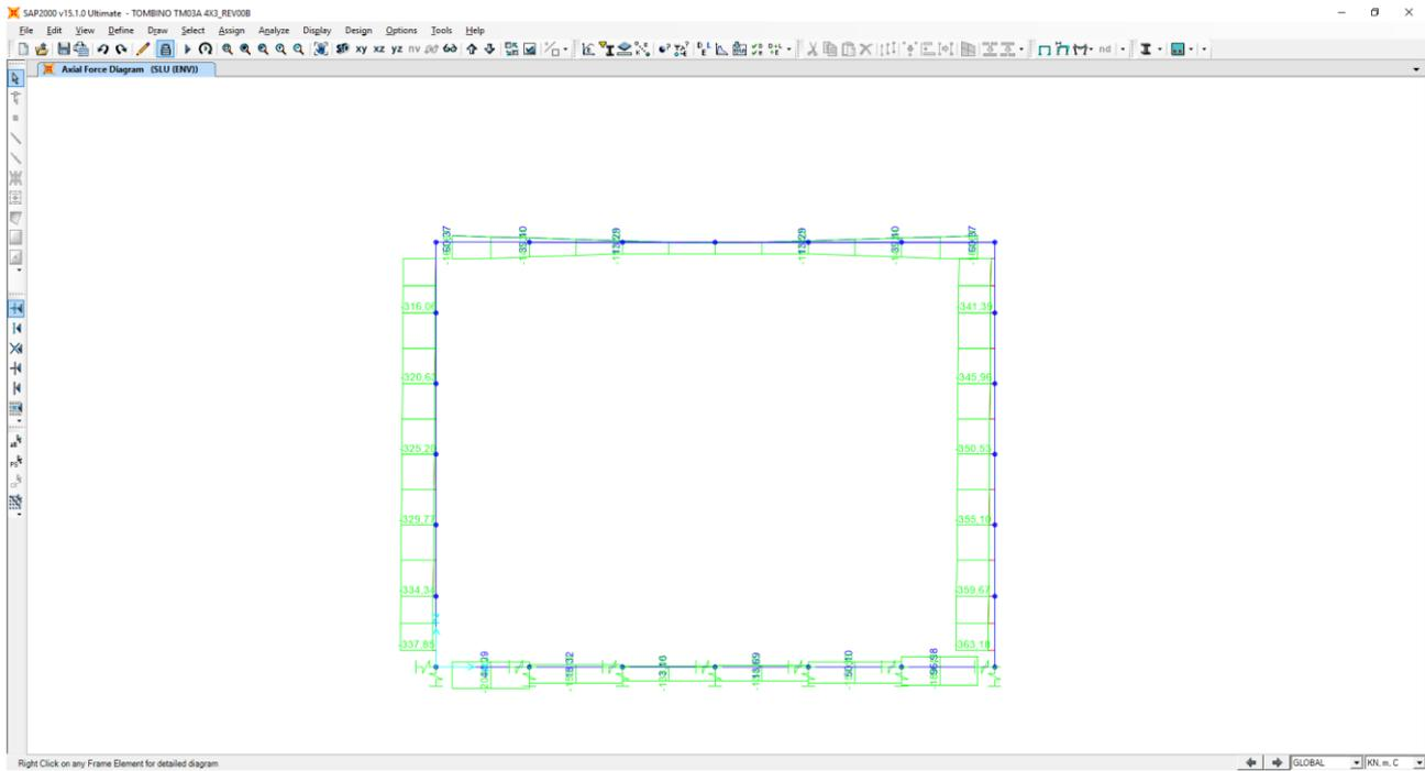
Nel diagramma successivo è riportato l'andamento del momento flettente per la combinazione di involuppo delle combinazioni di carico allo SLU – STR:
