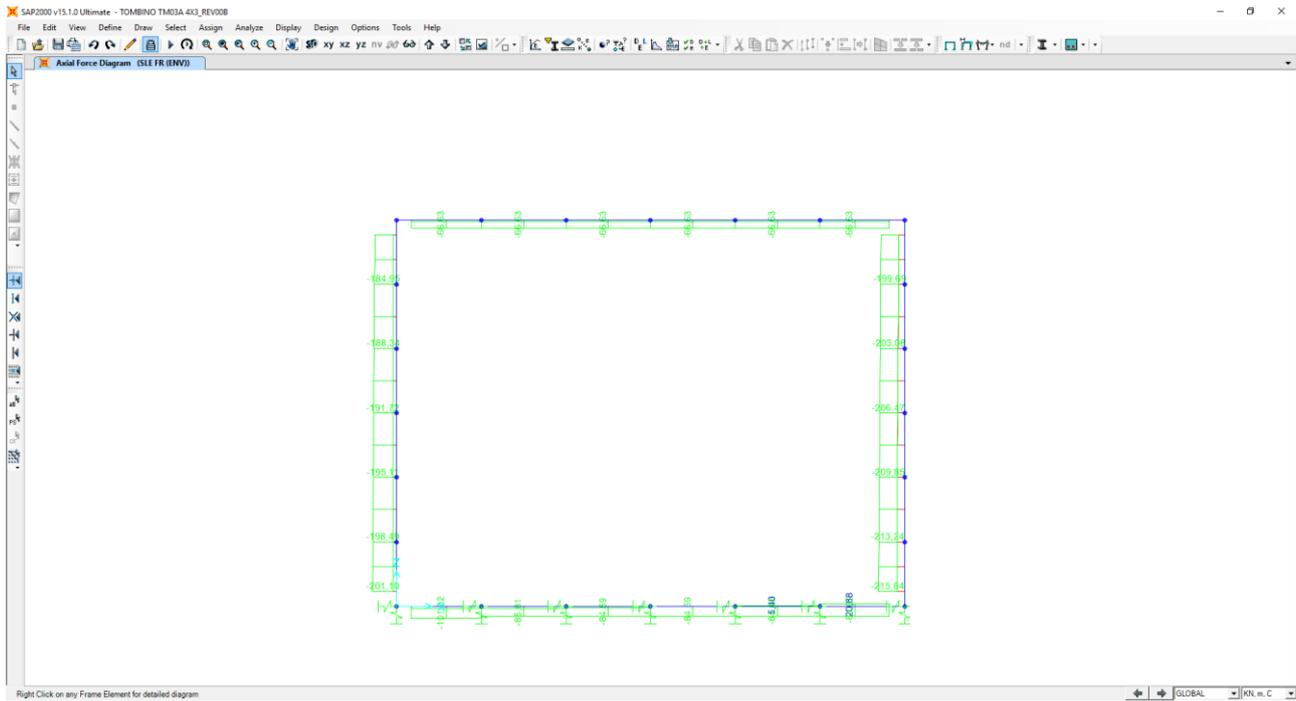
Nel diagramma successivo è riportato l'andamento del momento flettente per la combinazione di involuppo delle combinazioni di carico allo SLE – Frequenti:
