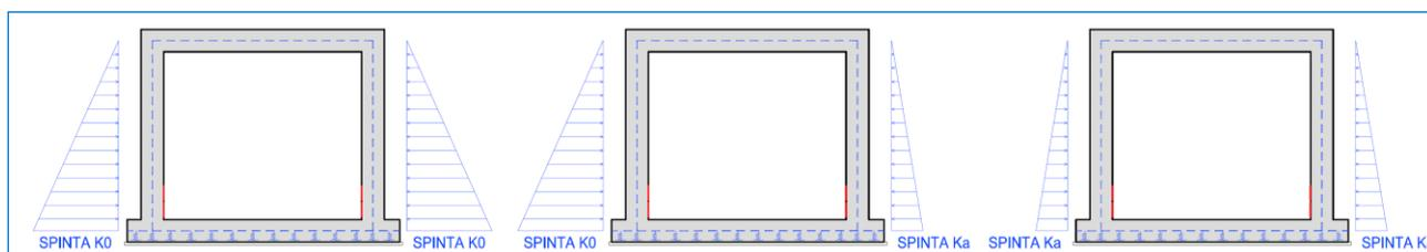
La spinta attiva è stata introdotta come load case nel software di calcolo partendo dal load pattern relativo alla spinta a riposo e moltiplicando quest'ultimo per un coefficiente riduttivo pari a:
