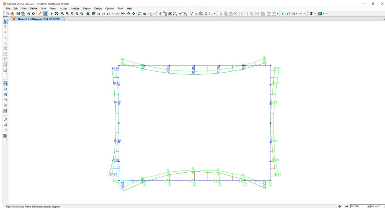
Nel diagramma successivo è riportato l'andamento dell'azione tagliante per la combinazione di involucro delle combinazioni di carico allo SLE – Quasi Permanenti:
