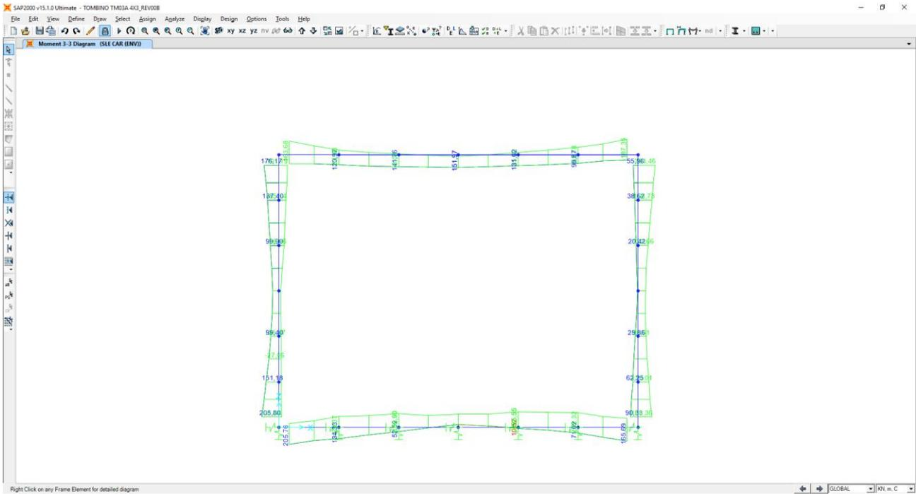
Nel diagramma successivo è riportato l'andamento dell'azione tagliante per la combinazione di involuppo delle combinazioni di carico allo SLE – Caratteristiche:
