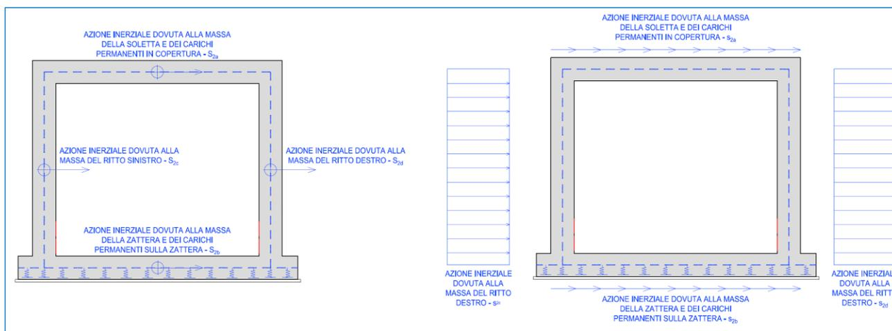
Nota Bene: le azioni inerziali sismiche sono applicate al modello solo in una direzione orizzontale (alla stregua di quanto già fatto per le spinte del terreno in condizione  $k_0/k_a$  e delle sovraspinte). L'output del modello, in termini di sollecitazioni flettenti e taglianti, è quindi di tipo asimmetrico. L'armatura è ovviamente stata progettata simmetrica e le verifiche sono state condotte con i valori massimi.
