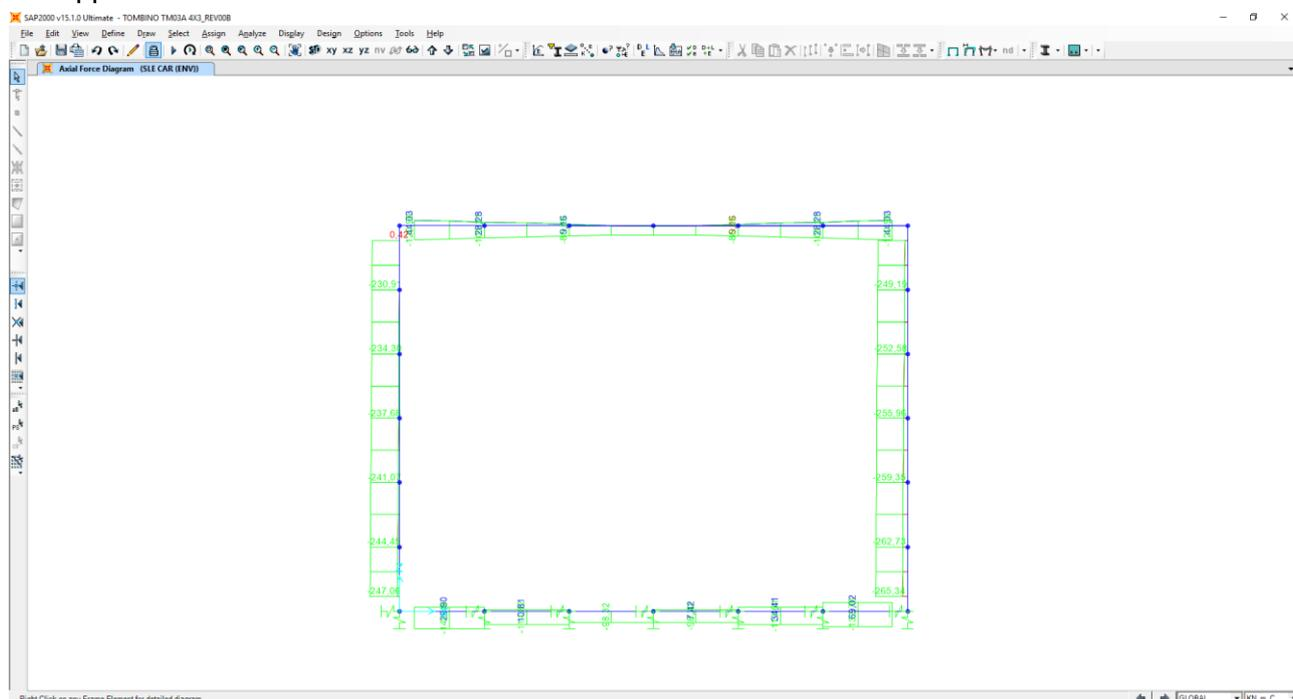
Nel diagramma successivo è riportato l'andamento del momento flettente per la combinazione di involuppo delle combinazioni di carico allo SLE – Caratteristiche:
