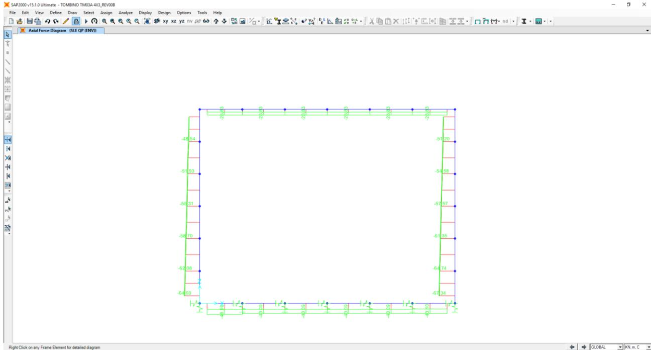
Nel diagramma successivo è riportato l'andamento del momento flettente per la combinazione di involucro delle combinazioni di carico allo SLE – Quasi Permanenti:
