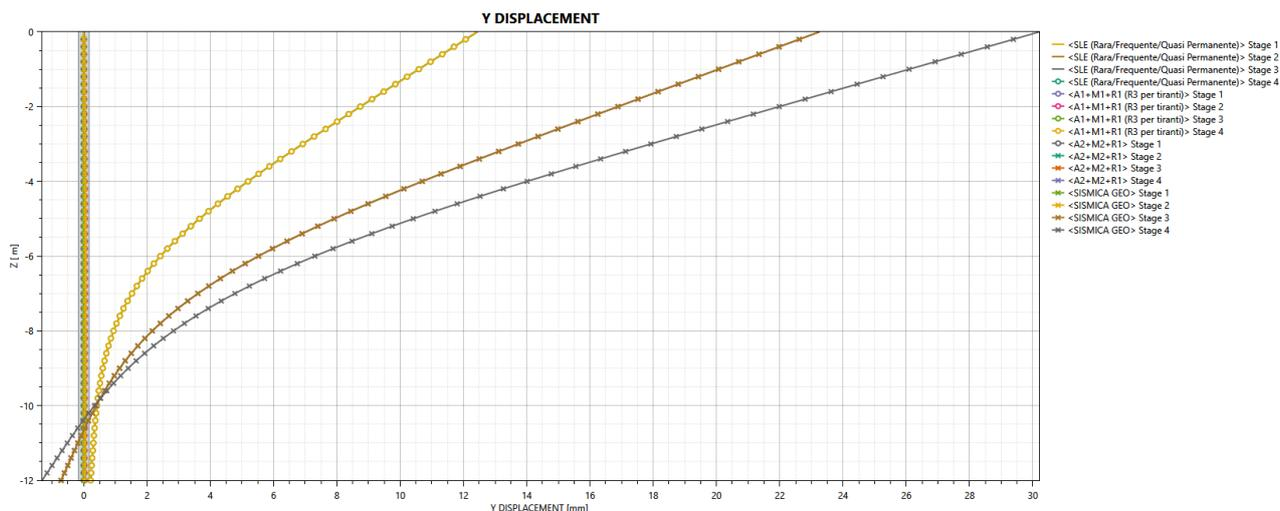
Lo spostamento massimo in testa della paratia è stato determinato pari a **30,206 mm** (combinazione sismica SLV).
