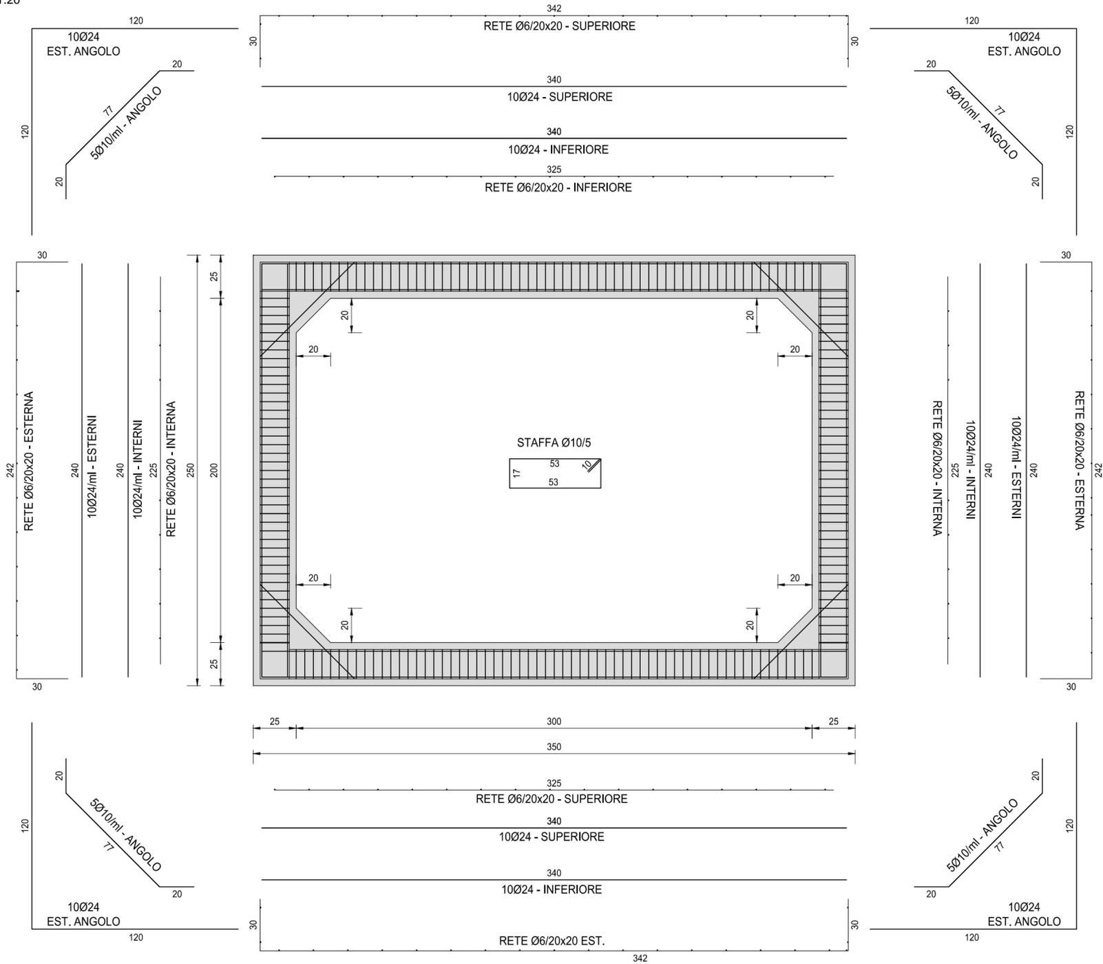
**SEZIONE TRASVERSALE DELLA SOLETTA DI RIPARTIZIONE INFERIORE**
