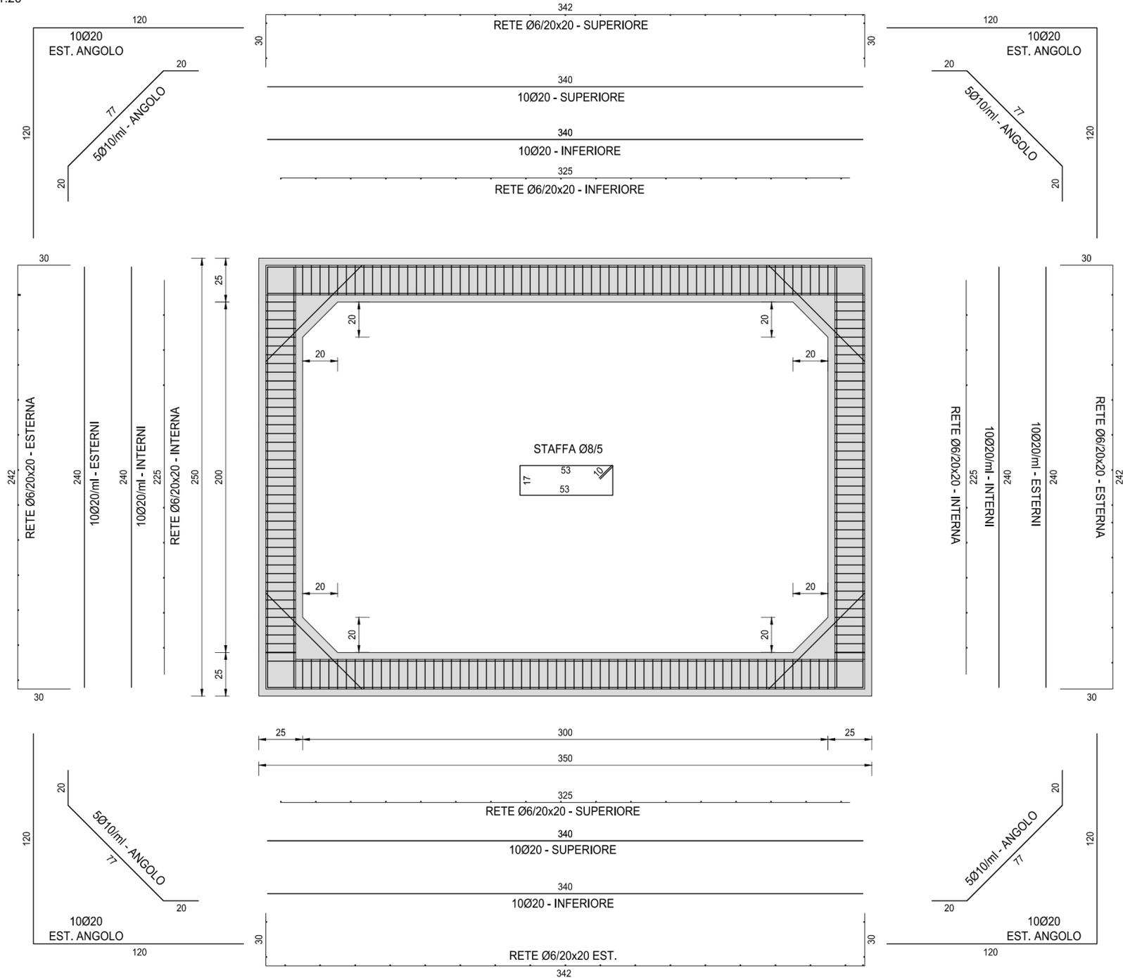
**SEZIONE TRASVERSALE DELLA SOLETTA DI RIPARTIZIONE INFERIORE**
