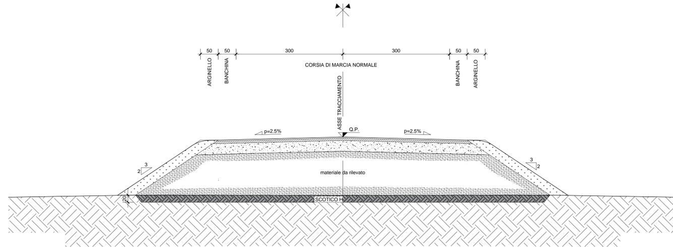
SEZIONE TIPO IN TRINCEA CON LARGHEZZA 7 m scala 1:50
