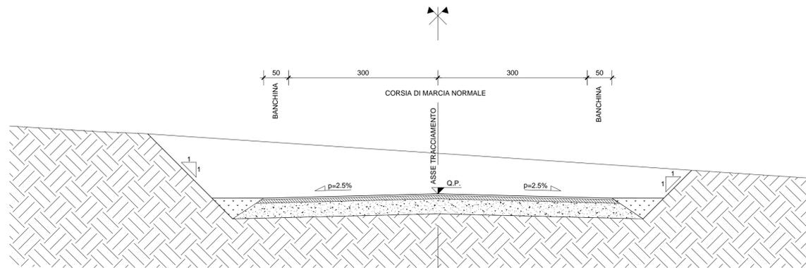
SEZIONE TIPO IN MEZZACOSTA CON LARGHEZZA 7 m scala 1:50
