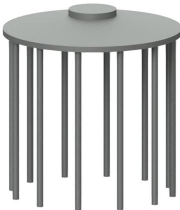
Figura 2: vista tridimensionale della fondazione dell'aerogeneratore
