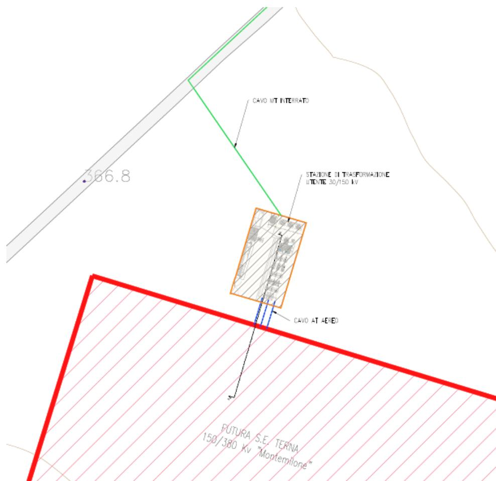
Figura 3 – Planimetria della stazione elettrica utente
