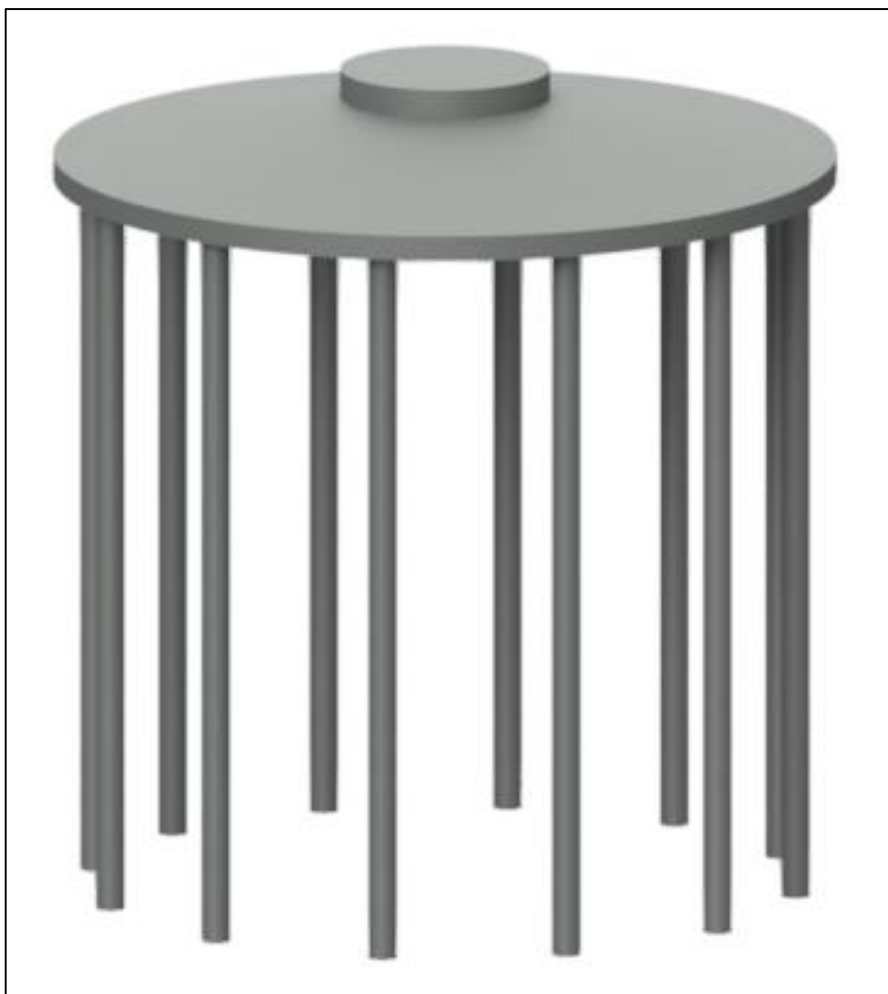
Figura 4: vista tridimensionale della fondazione dell'aerogeneratore
