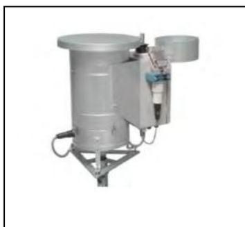
Tale apparecchio si attiva in assenza di precipitazioni raccogliendo il materiale sedimentato. Quest'ultimo viene poi valutato per microscopia ottica automatica dopo essere stato raccolto su adeguato vetrino di osservazione. La foto di seguito riportata si riferisce ad un campione di particolato atmosferico sedimentato.
