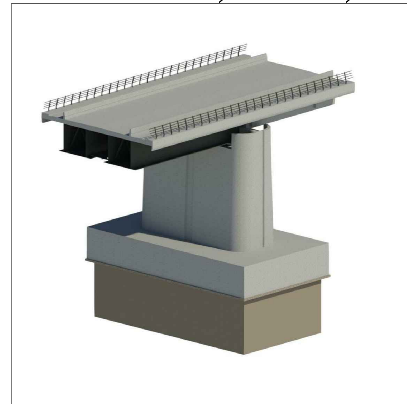
VISTA ASSONOMETRICA IMPALCATO IN ACCIAIO/CAP LUCE 45/25 m
