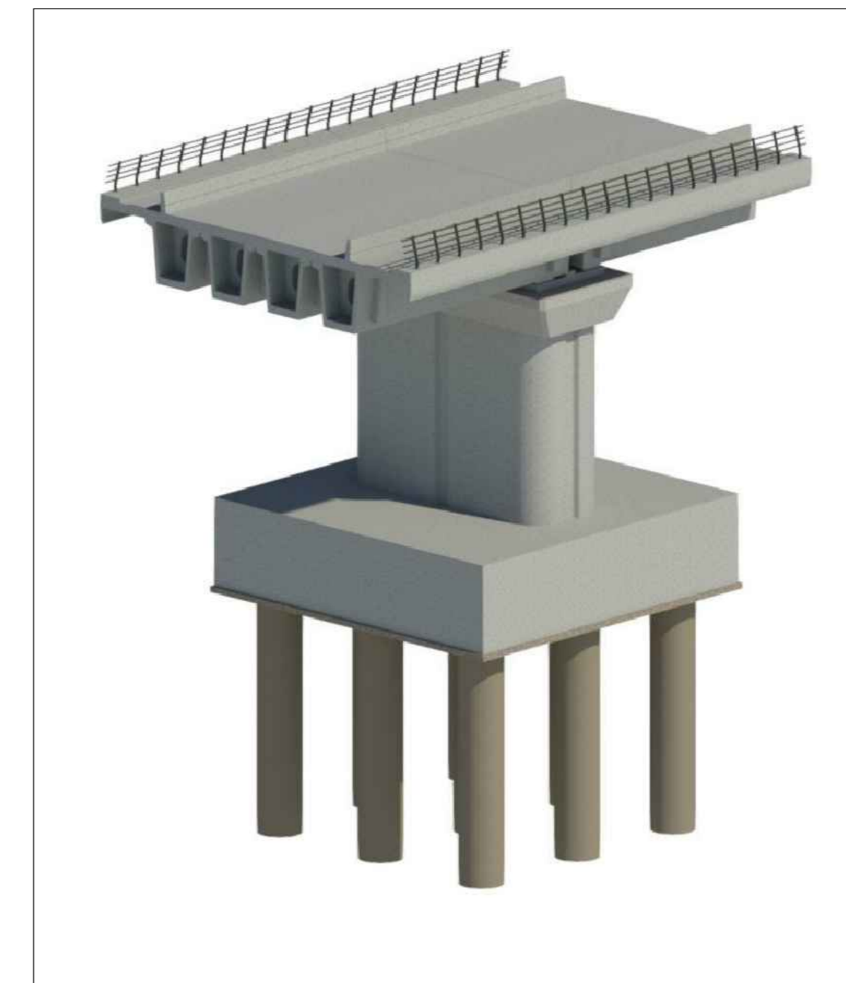
VISTA ASSONOMETRICA IMPALCATO IN CAP LUCE 25 m
