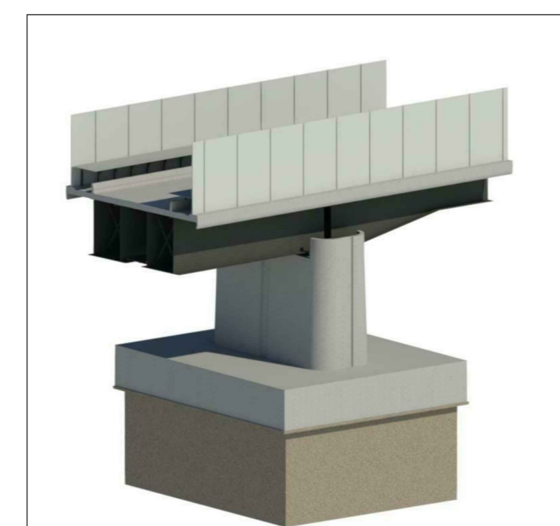
VISTA ASSONOMETRICA IMPALCATO IN ACCIAIO LUCE 65/45 m
