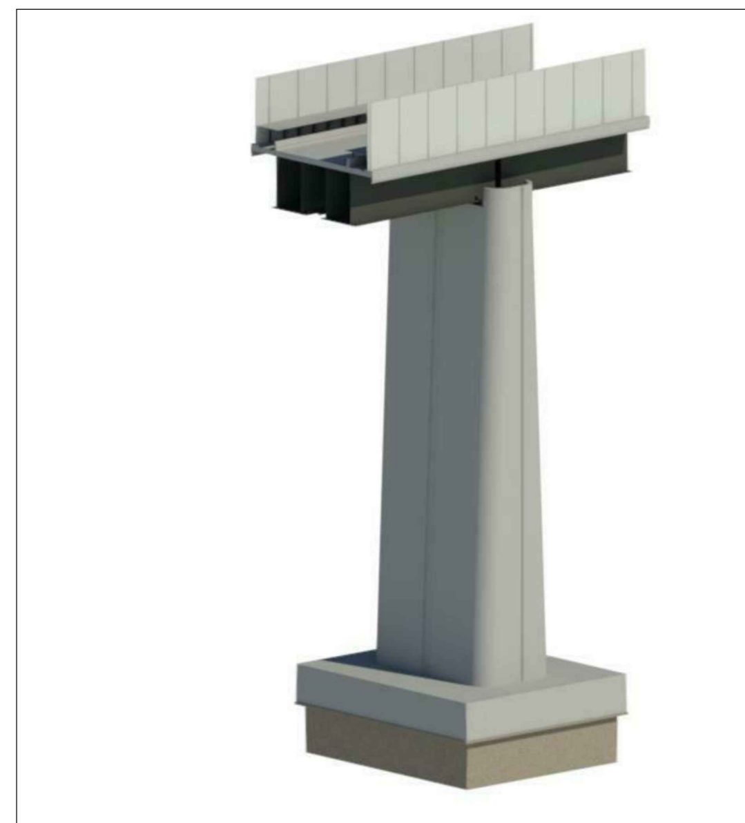
VISTA ASSONOMETRICA IMPALCATO IN ACCIAIO LUCE 65 m
