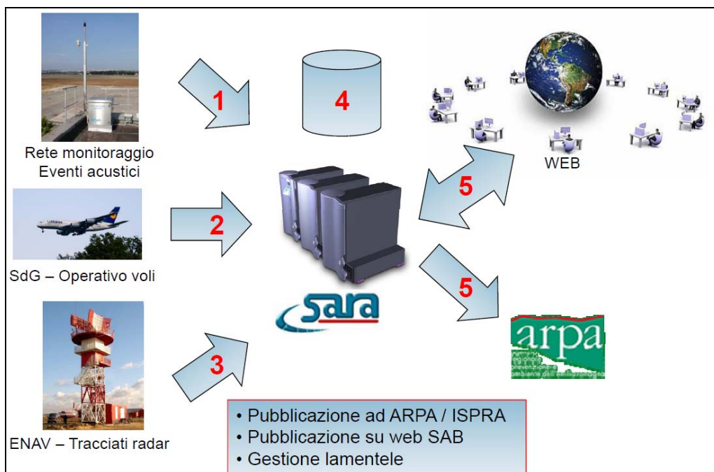
Img. 3.5 – Schema di funzionamento del sistema di monitoraggio del rumore aeroportuale
