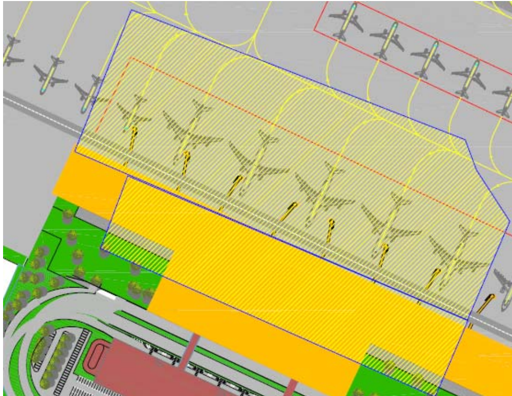
Img. 5.8 - Sovrapposizione delle aree pavimentate precedentemente descritte sulle aree che verranno interessate dalle nuove realizzazioni
