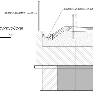
Particolare pavimentazione bituminosa
