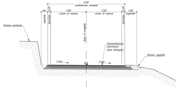
Sezione Tipo viabilità esistente
