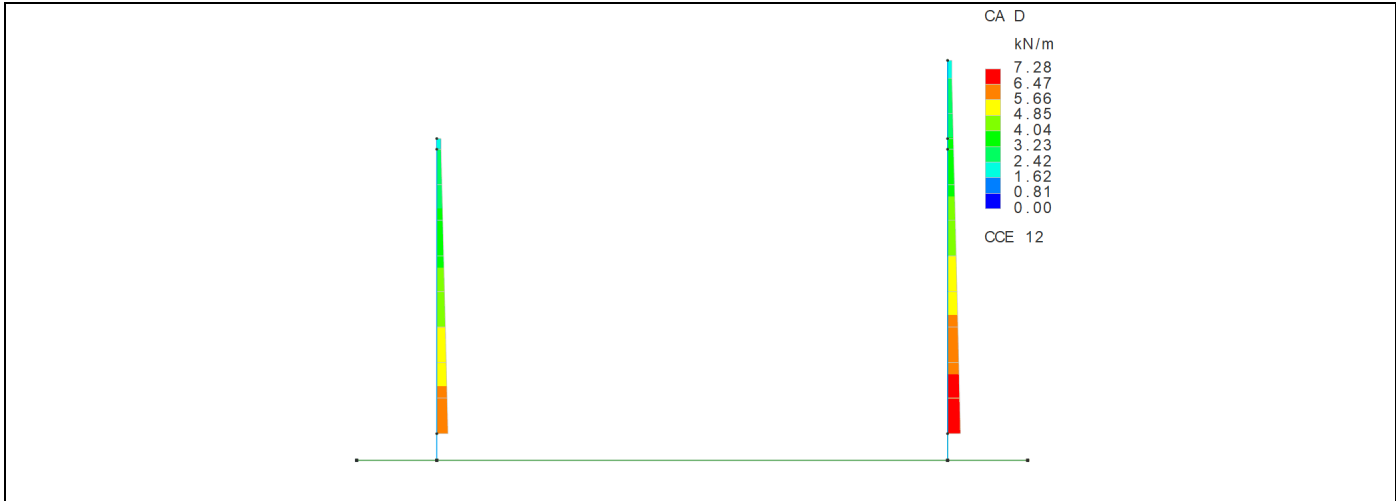
Figura 83 – CCE 12, forze di inerzia orizzontali
