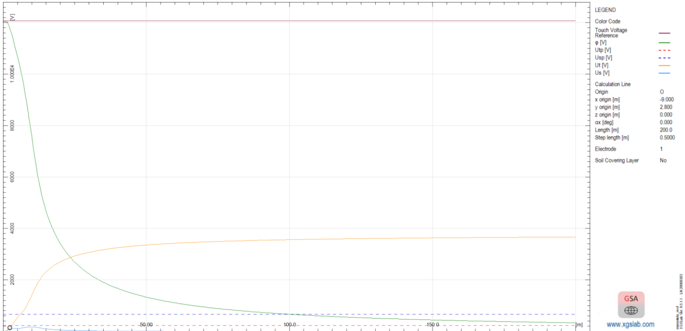
Figura 6.6b: Distribuzione potenziali lungo la direttrice di calcolo
