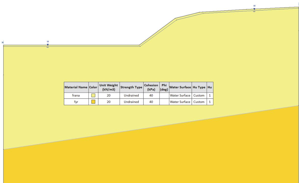
Figura 8: Viabilità di accesso alla NV05. Modello di calcolo dello scavo per la realizzazione dei gabbioni.
