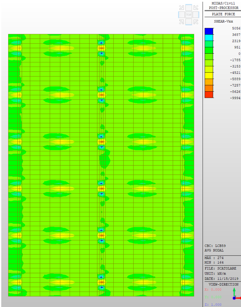
Figura 10.26 – Platea - Involuppo Taglio V11 (trasversale) – massimo taglio in corrispondenza del piedritto laterale
