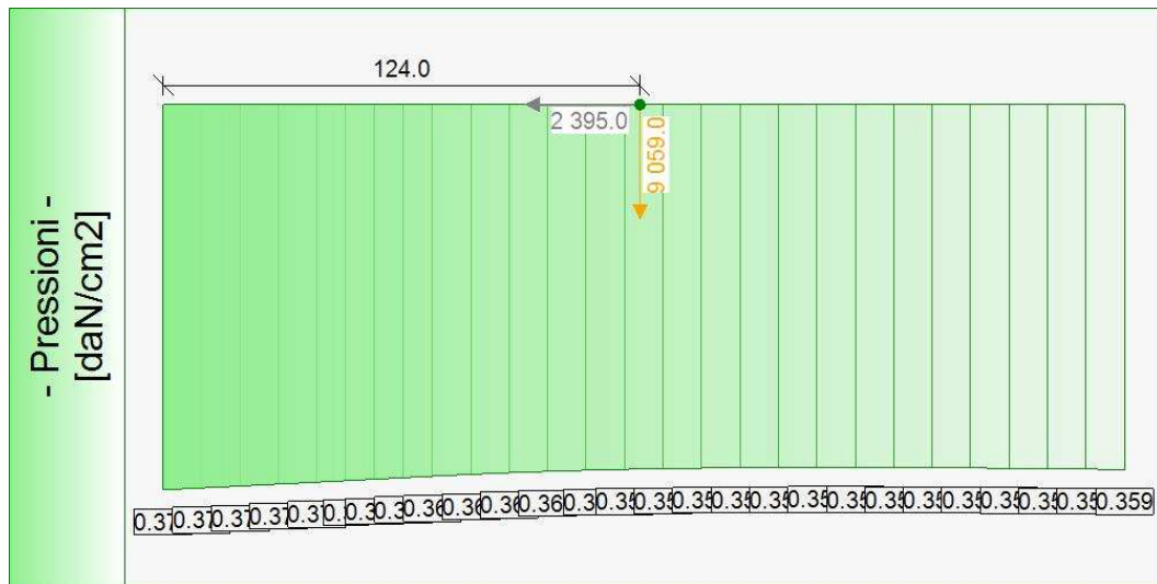
Forze (totali) e Pressioni lungo il fusto, per il Caso 3 ( EQU [ SLU_EQU ] - SLU_Equ (per equilibrio) )
