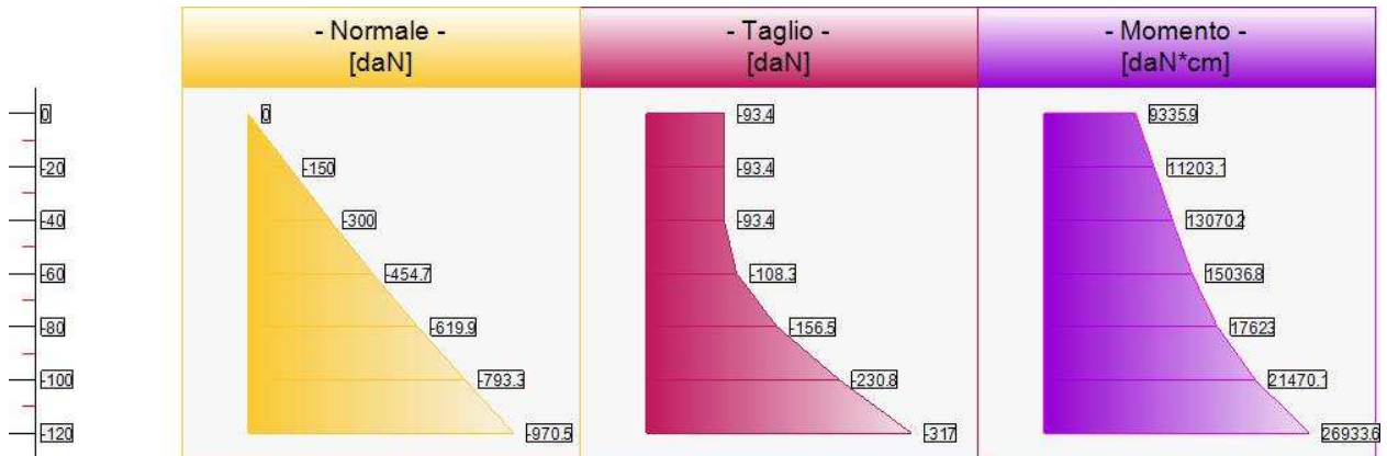
Sollecitazioni lungo il fusto, per il Caso 10 ( RARA [ Rara ] - Combinazione caratteristica (rara) - SLE )
