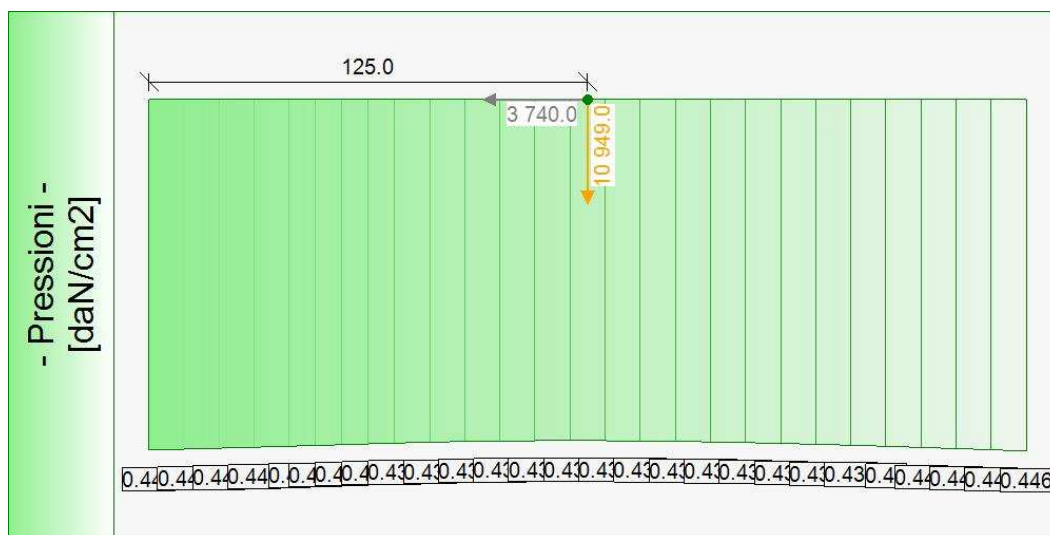
Forze (totali) e Pressioni lungo il fusto, per il Caso 9 ( EQU_SISMA_GIU [ SLU_EQU ] - SLU_Equ_Sisma_Giu (per equilibrio) )
