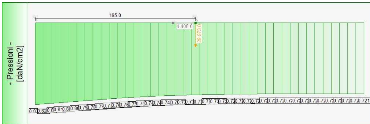
Forze (totali) e Pressioni lungo il fusto, per il Caso 10 ( RARA [ Rara ] - Combinazione caratteristica ( rara ) - SLE )
