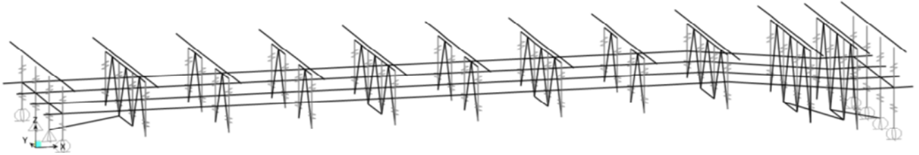
Fig. 30 – Modello FEM – vista 3D: elementi che rappresentano le travi ed i diaframmi
