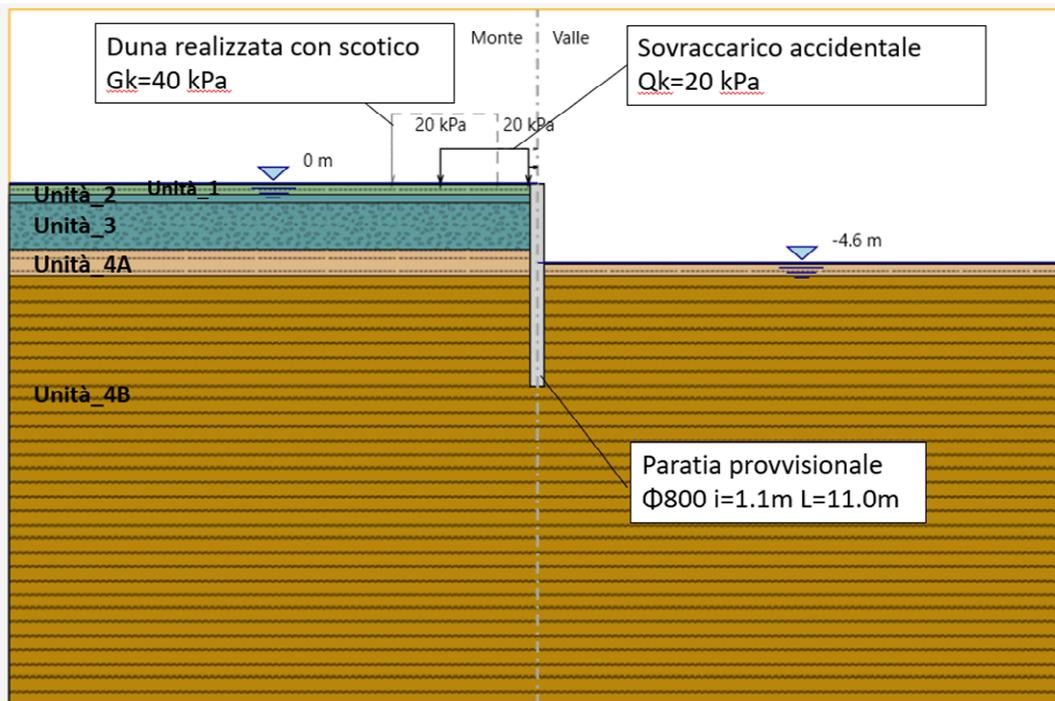
Figura 9.1. P3. Modello di calcolo implementato nel software ParatiePlus 2020
