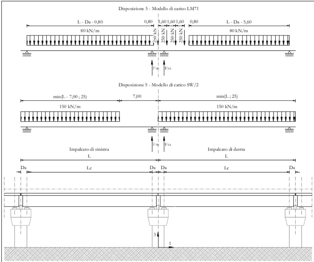
**Figura 6.6 Disposizione di carico 5**
