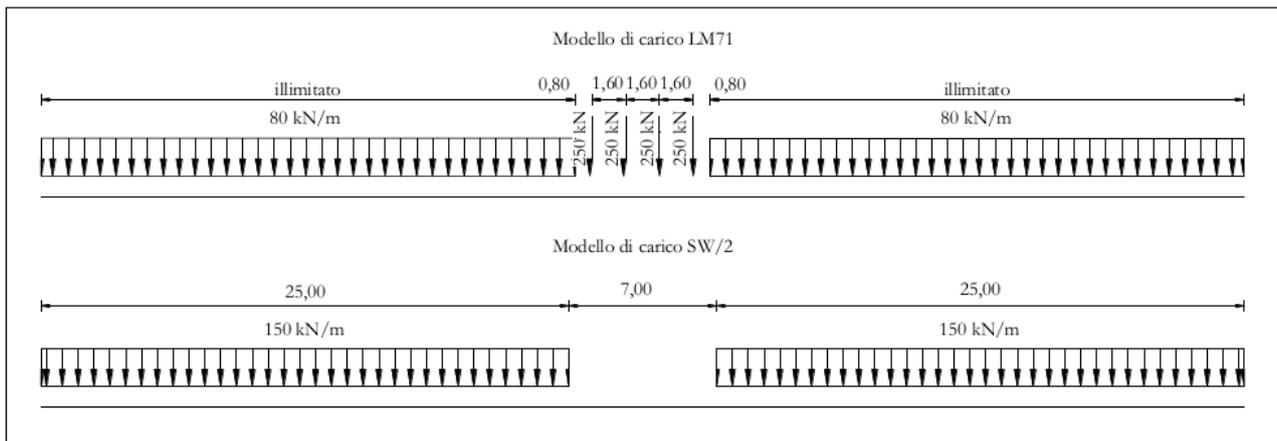
Le differenti disposizioni degli assi e delle stese di carico considerate sono state definite in modo tale da massimizzare gli scarichi sulla pila:
