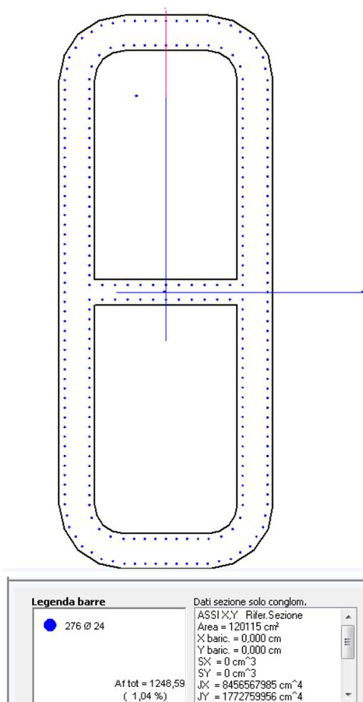
Figura 9.1 Disposizione dell'armatura verticale
