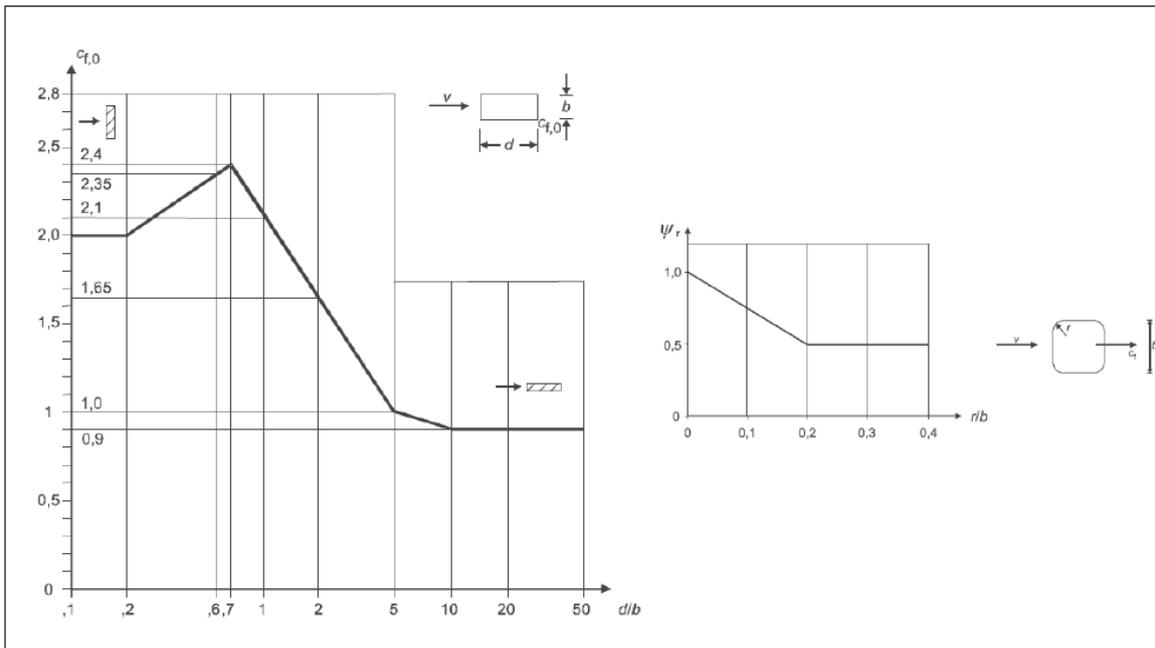
Figura 6.12 – Determinazione del coefficiente di forma  $c_{f,0}$  in funzione delle dimensioni della sezione (fig. 7.23 EC1-4) e correlazione tra il raggio di arrotondamento dello spigolo e il fattore riduttivo  $\psi_r$  (fig. 7.24 EC1-4)
